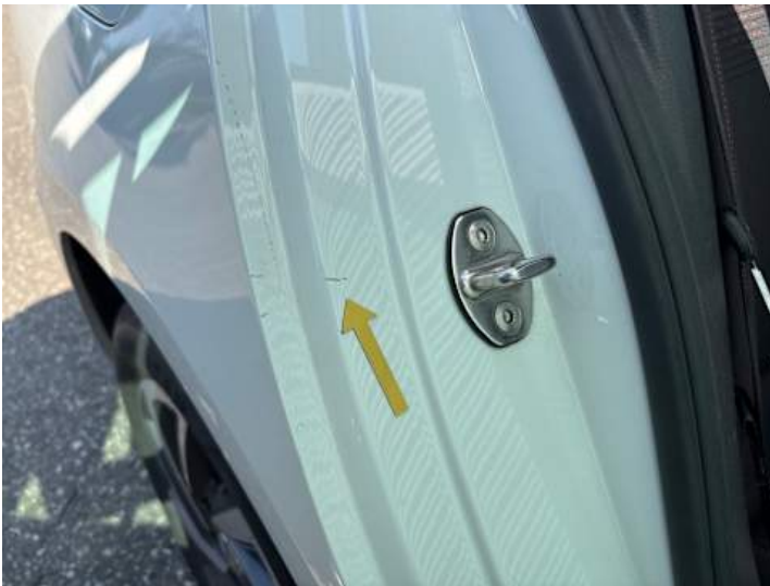
Türe hinten rechts (Kratzer, Lackschaden)
