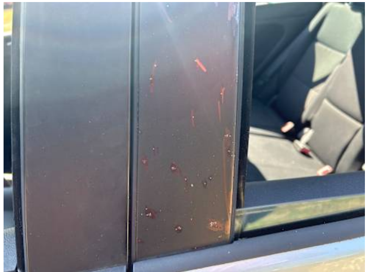
Türe hinten links (Lackschaden)
