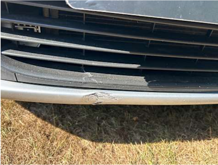
Stoßstange vorne (Lackschaden, Riss/Bruch)
