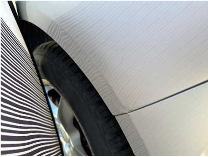
Seitenteil hinten links (Lackschaden, Verformung)
