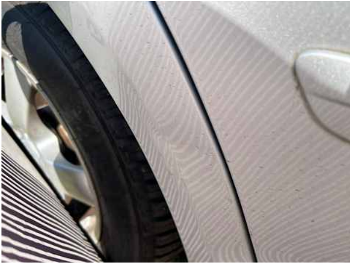
Seitenteil hinten rechts (Verformung)
