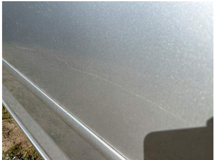
Beifahrtür (Kratzer, Lackschaden)
