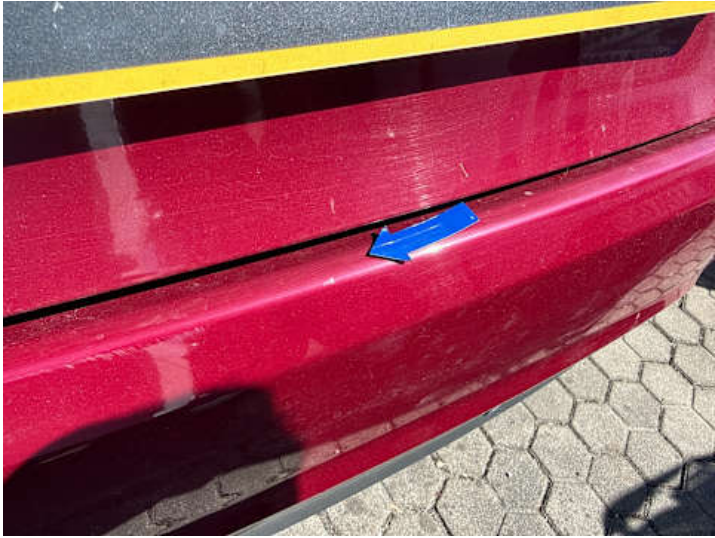
Stoßstange hinten (Kratzer, Delle, Lackschaden)
