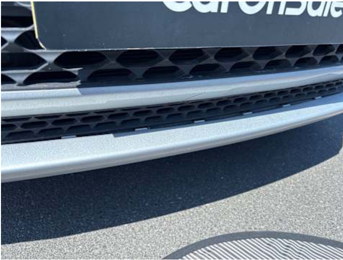
Stoßstange vorne (Spaltmaße ungenau)
