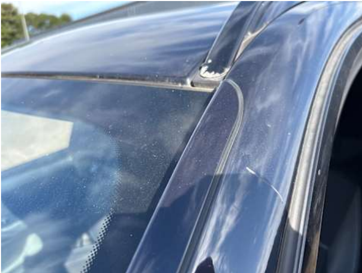
Dach (Lackschaden, Kratzer)
