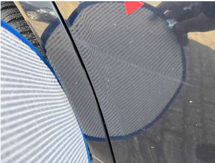
Türe hinten rechts (Kratzer, Verformung)
