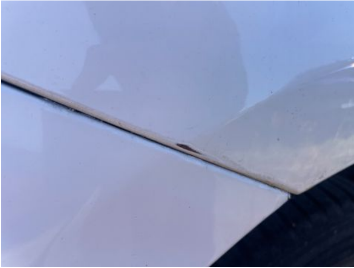
Seitenteil hinten rechts (Lackschaden)
