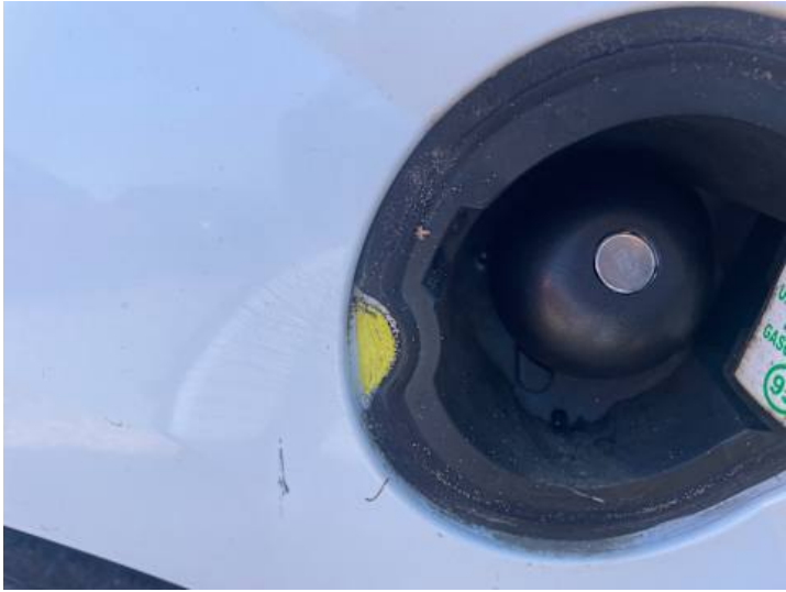
Seitenteil hinten rechts (Lackschaden)
