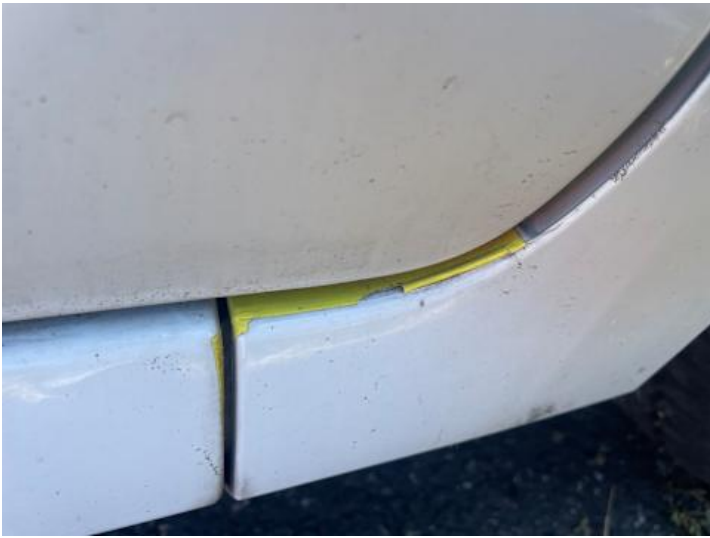
Kotflügel vorne rechts (Lackschaden)
