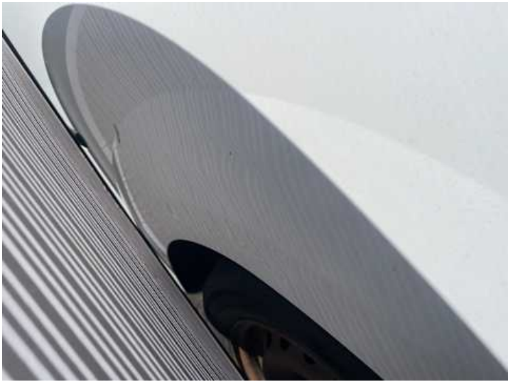
Seitenteil hinten links (Verformung)
