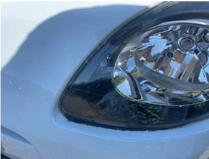
Scheinwerfer (links) (Riss/Bruch)
