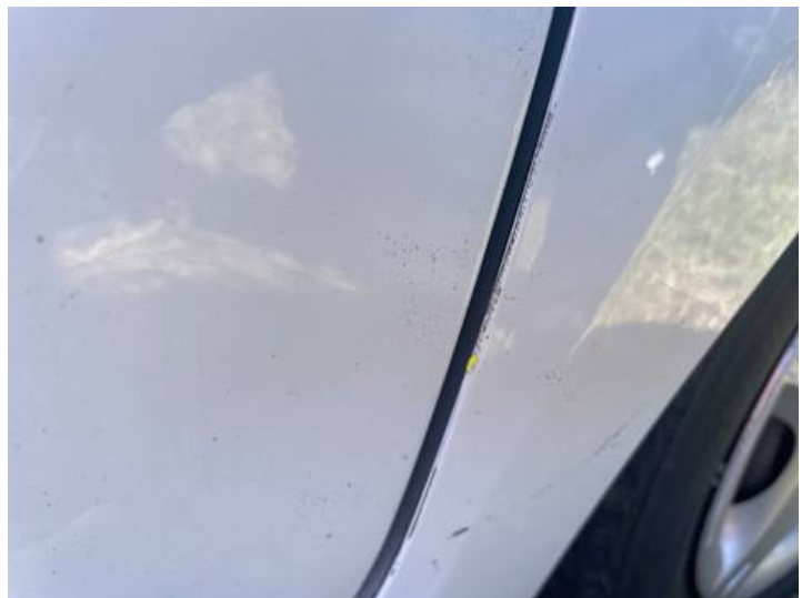
Kotflügel vorne rechts (Lackschaden)
