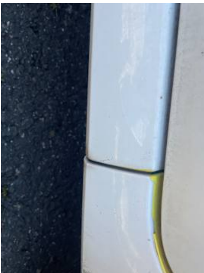
Schweller rechts (Lackschaden)
