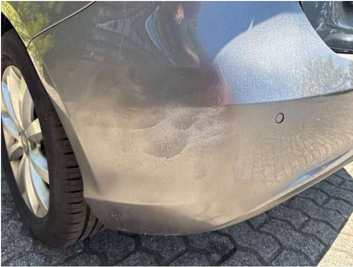
Stoßstange hinten (Lackschaden, Riss/Bruch, Unsachgemäß instand gesetzt)
