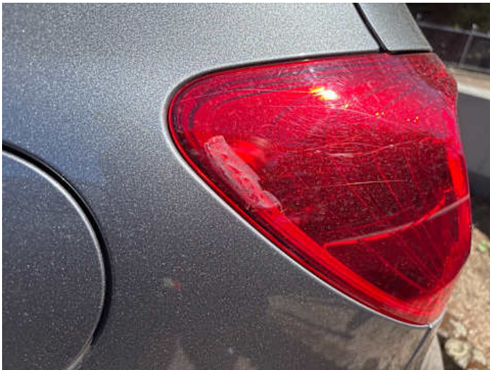
Rücklicht (links) (Riss/Bruch)
