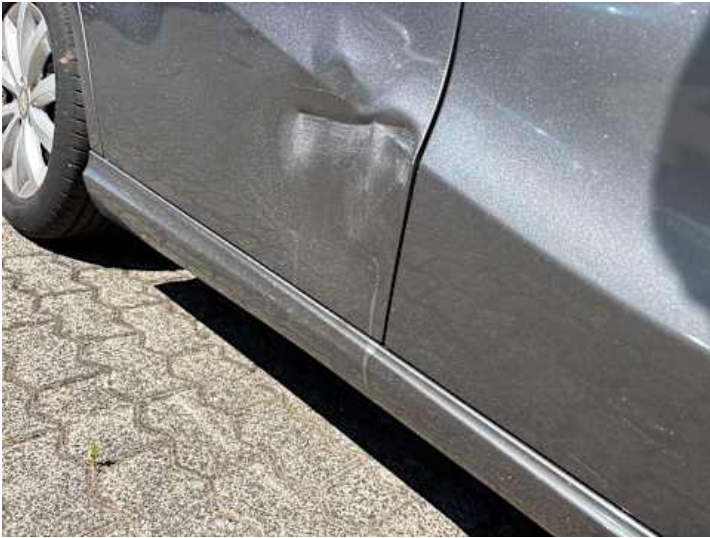
Türe hinten rechts (Verformung, Lackschaden, Unsachgemäß instand gesetzt)
