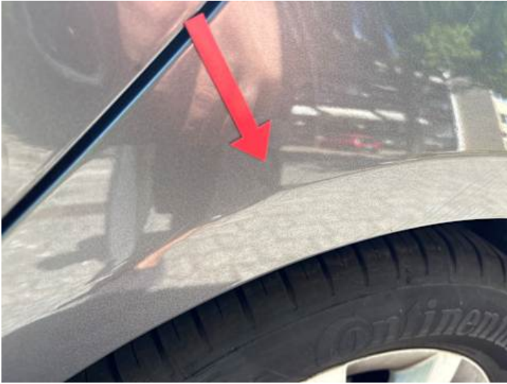
Seitenteil hinten links (Kratzer, Lackschaden)
