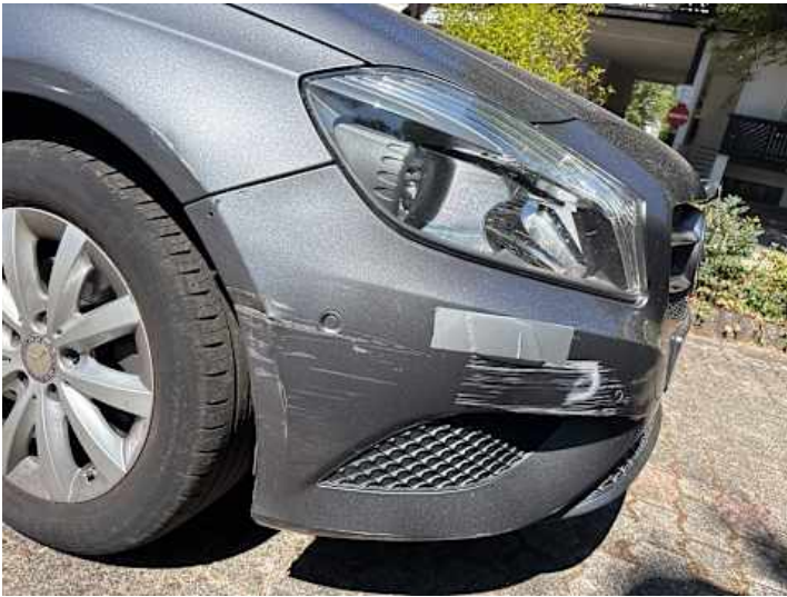
Stoßstange vorne (Lackschaden, Riss/Bruch)
