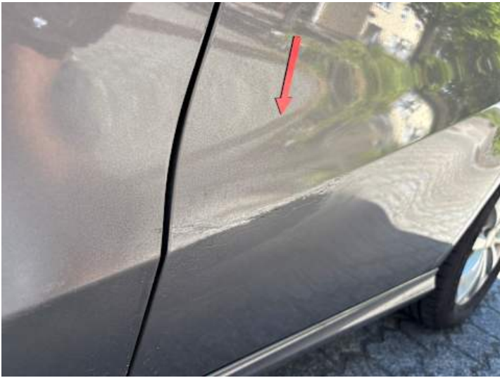
Türe hinten links (Lackschaden, Verformung, Unsachgemäß instand gesetzt)
