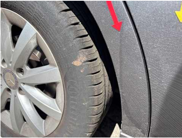
Seitenteil hinten rechts (Verformung)
