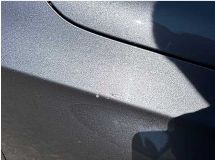
Kotflügel vorne rechts (Lackschaden, Verformung)
