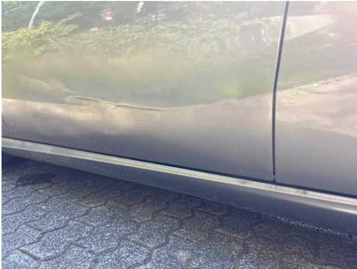
Fahrtür (Lackschaden, Verformung, Unsachgemäß instand gesetzt)
