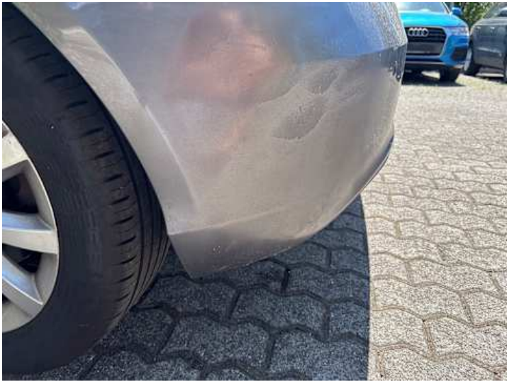
Stoßstange hinten (Lackschaden, Riss/Bruch, Unsachgemäß instand gesetzt)
