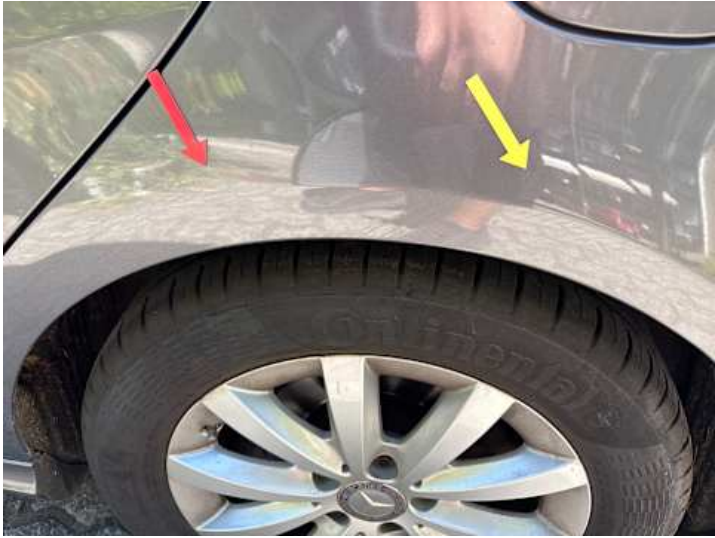
Seitenteil hinten links (Kratzer, Lackschaden)
