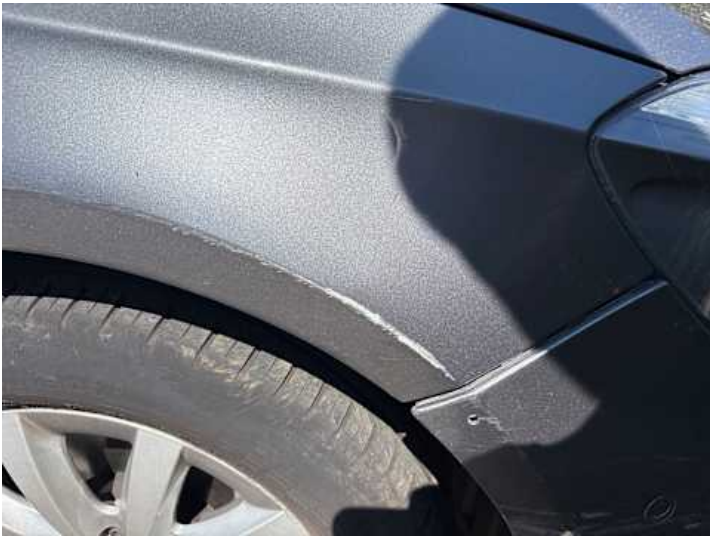
Kotflügel vorne rechts (Lackschaden, Verformung)
