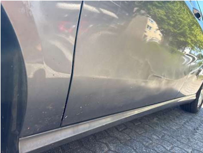
Fahrtür (Lackschaden, Verformung, Unsachgemäß instand gesetzt)
