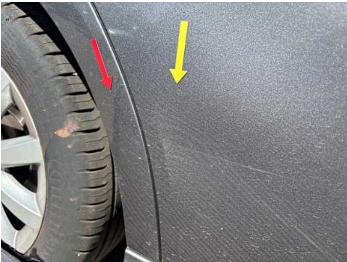
Türe hinten rechts (Kratzer, Verformung)
