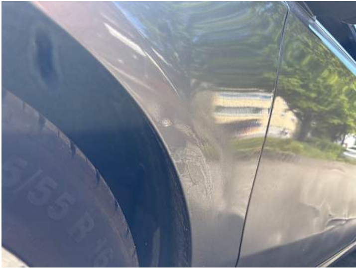
Kotflügel vorne links (Lackschaden, Verformung, Unsachgemäß instand gesetzt)
