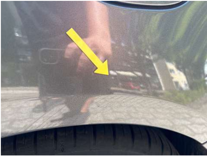
Seitenteil hinten links (Kratzer, Lackschaden)
