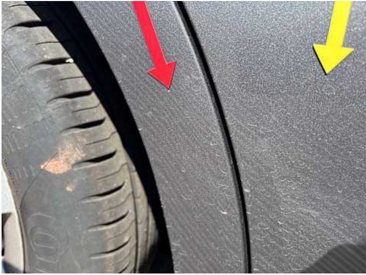
Seitenteil hinten rechts (Verformung)
