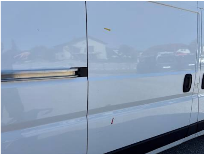
Türe hinten rechts (Delle, Kratzer)
