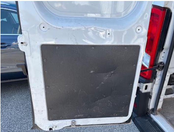
Innenraum (Riss/Bruch, Kratzer)
