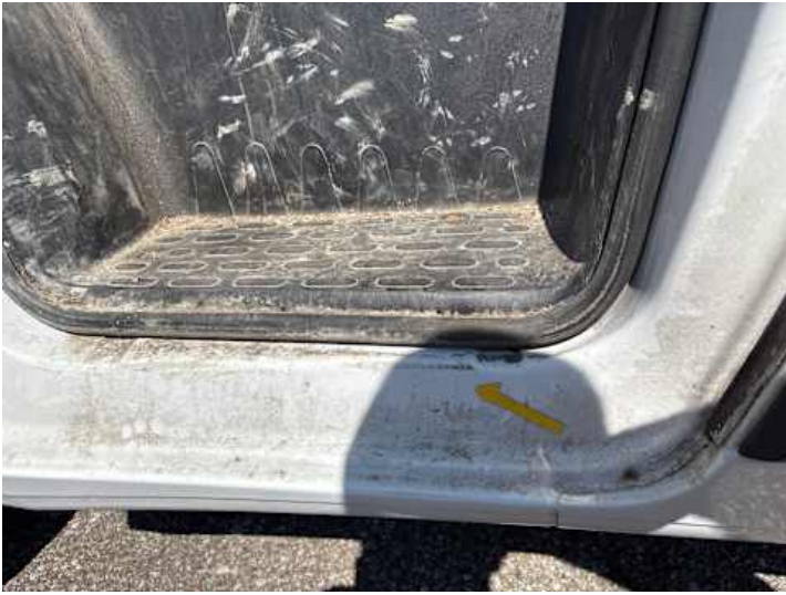
Schweller links (Lackschaden)
