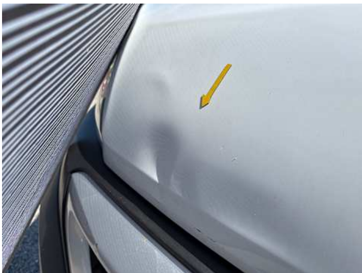
Motorhaube (Delle, Lackschaden)
