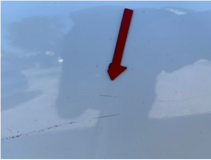
Türe hinten rechts (Delle, Kratzer)
