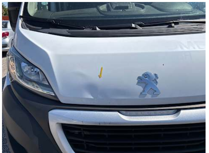
Motorhaube (Delle, Lackschaden)
