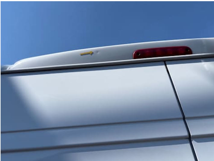
Dach (Delle, Kratzer)
