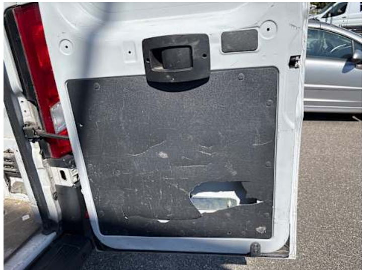
Innenraum (Riss/Bruch, Kratzer)
