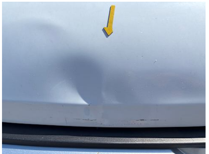
Motorhaube (Delle, Lackschaden)
