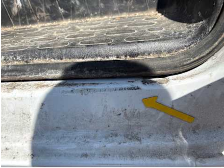
Schweller links (Lackschaden)
