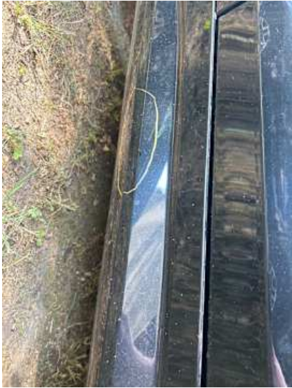
Schweller links (Kratzer)
