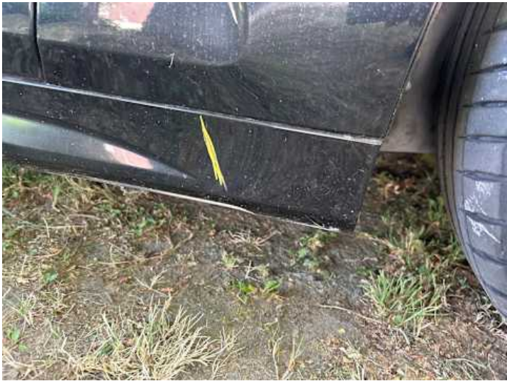
Schweller rechts (Kratzer)
