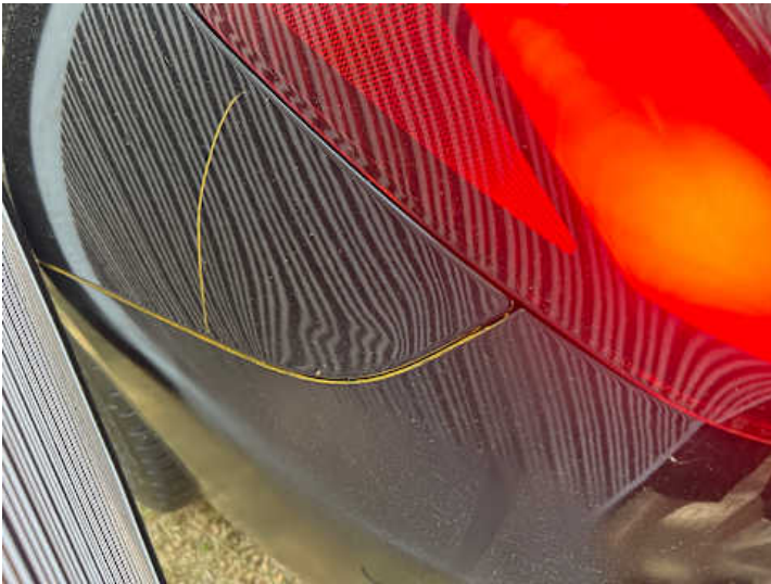
Seitenteil hinten links (Verformung, Unsachgemäß instand gesetzt)
