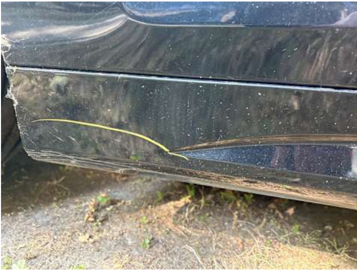
Schweller links (Kratzer)
