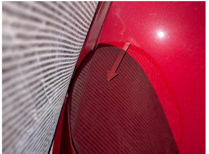
Motorhaube (Delle, Lackschaden)
