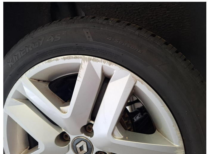
Bild 8: Außen, Felge hinten rechts - Radzierdeckel, verschrammt, erneuern
