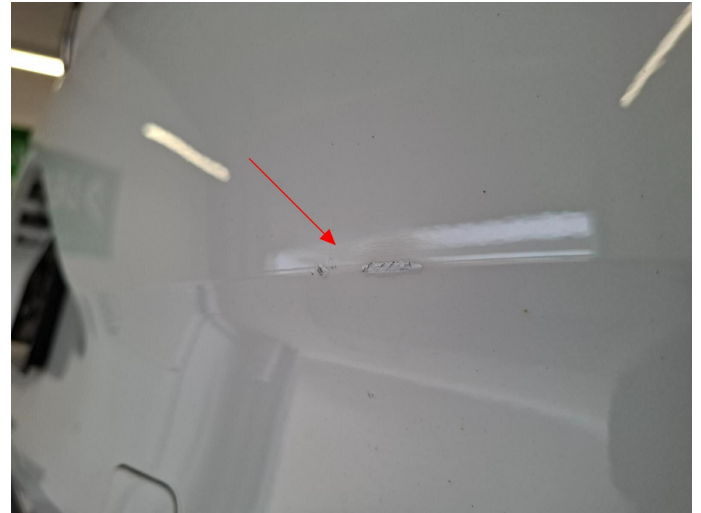
Bild 6: Außen, Stoßfänger hinten, verformt, erneuern
