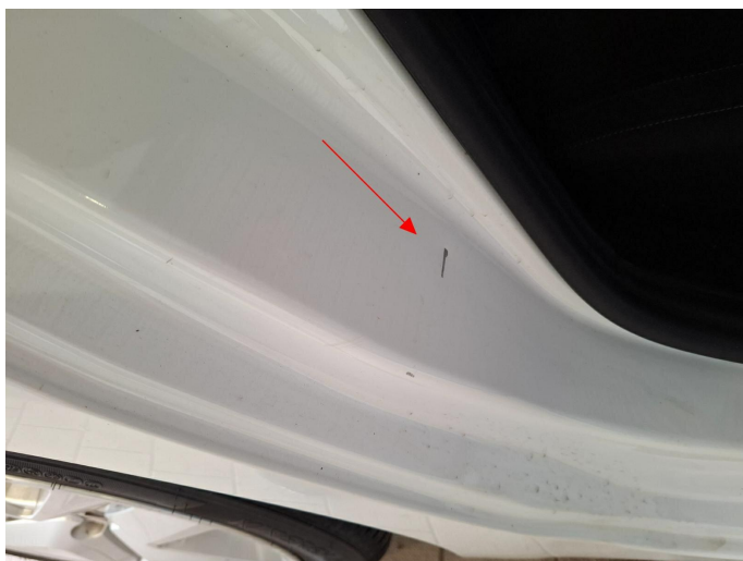
Bild 3: Außen, Tür hinten rechts - Einstieg, verschrammt, lackieren mit Lackaufbau
