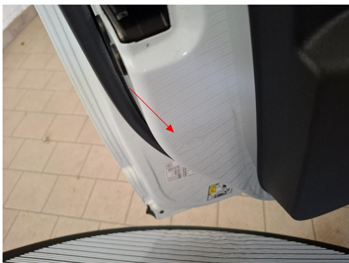
Bild 1: Außen, Tür vorne links - innen, eingedellt, drücken
