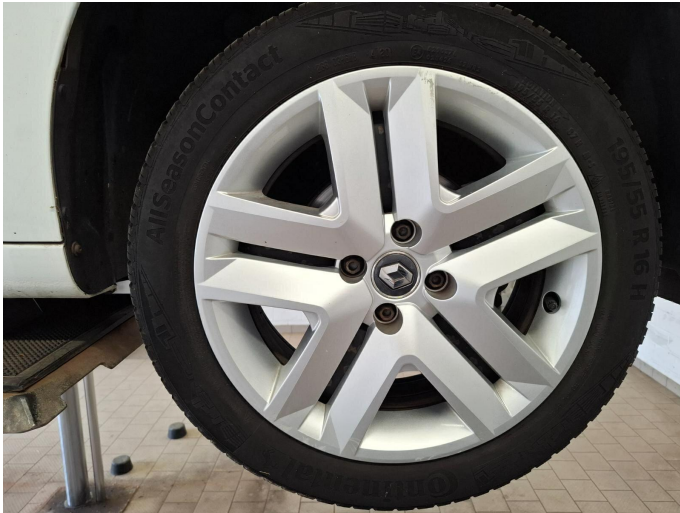
Bild 5: Außen, Felge vorne rechts - Radzierdeckel, verschrammt, erneuern
