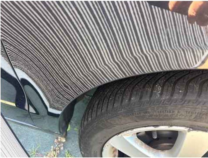
Kotflügel vorne rechts (Verformung)
