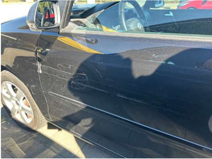
Fahrtür (Kratzer, Verformung)
