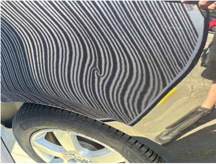
Seitenteil hinten rechts (Verformung)
