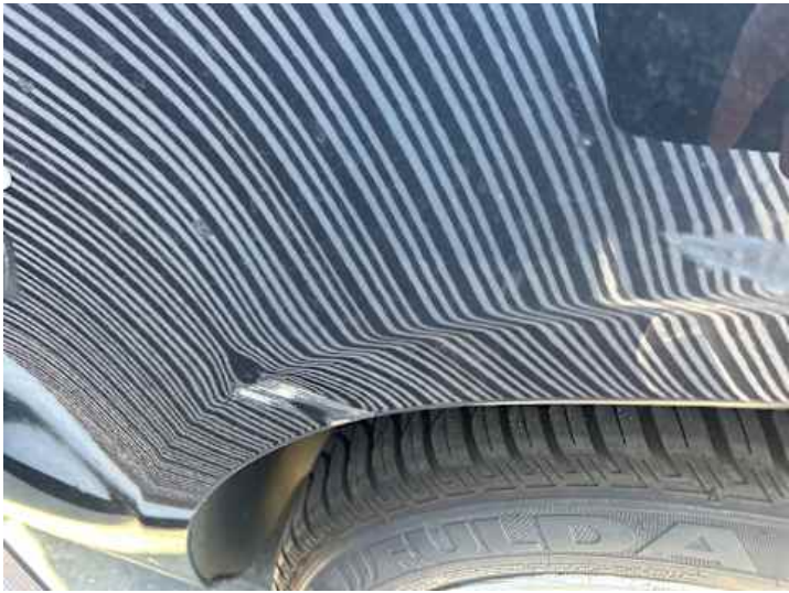
Seitenteil hinten links (Verformung, Kratzer)
