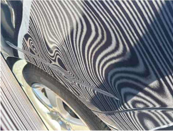
Seitenteil hinten links (Verformung, Kratzer)
