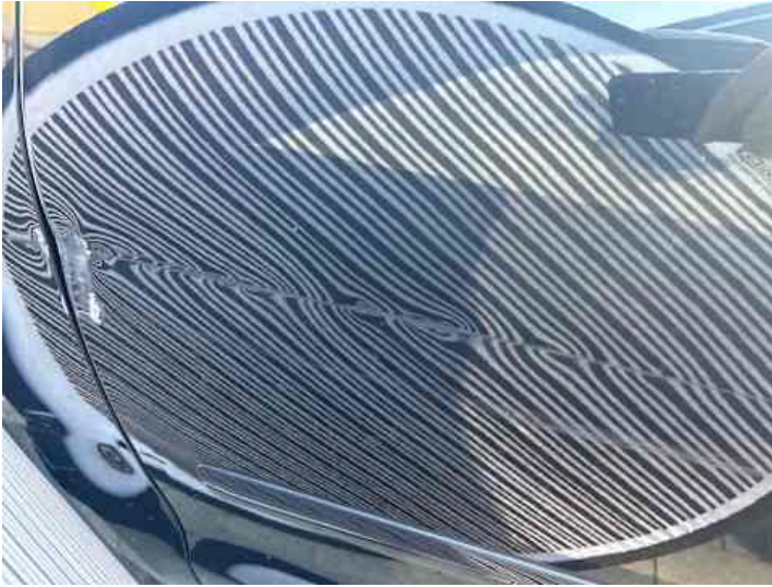
Fahrtür (Kratzer, Verformung)
