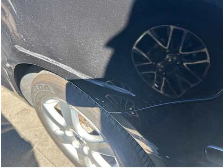
Seitenteil hinten links (Verformung, Kratzer)
