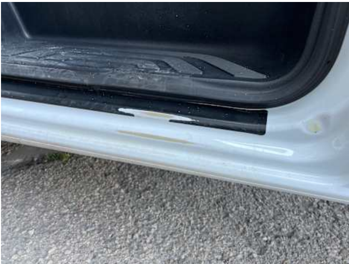
Schweller links (Lackschaden)
