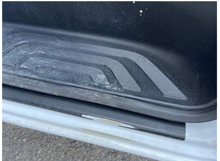
Schweller links (Riss/Bruch)
