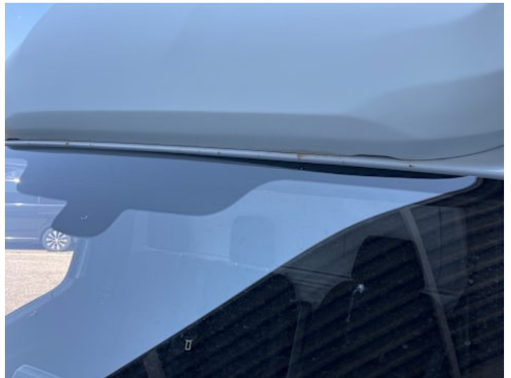
Dach (Steinschlag, Rost)
