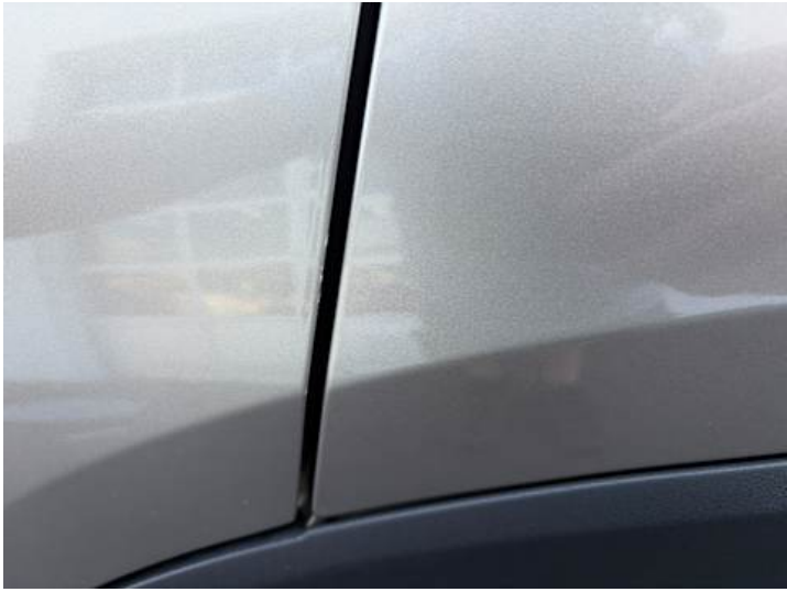
Türe hinten links (Lackschaden)
