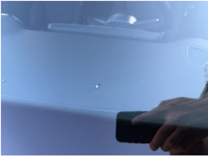
Windschutzscheibe (Riss/Bruch, Steinschlag)
