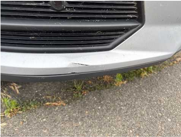
Stoßstange vorne (Lackschaden, Kratzer)
