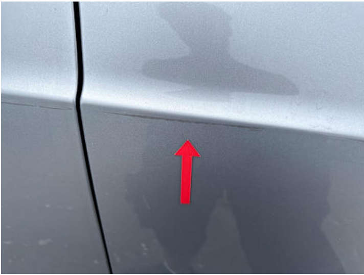
Kotflügel vorne rechts (Lackschaden)
