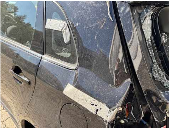
Seitenteil hinten links (Anderer Schaden): Kleberückstände
