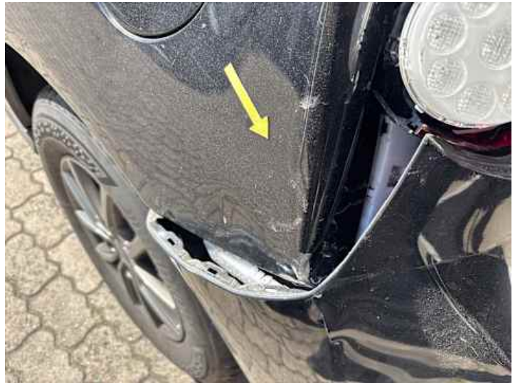
Seitenteil hinten links (Verformung, Riss/Bruch, Lackschaden)
