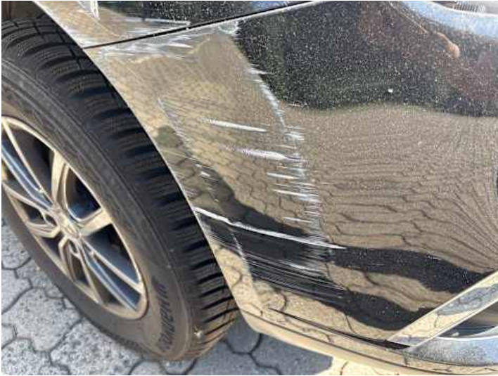
Stoßstange vorne (Kratzer, Lackschaden)
