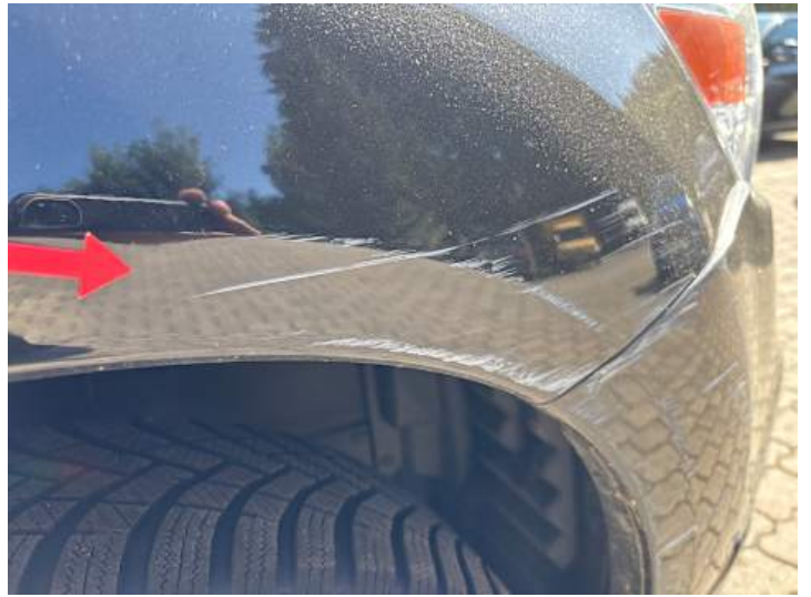
Kotflügel vorne rechts (Kratzer, Lackschaden)
