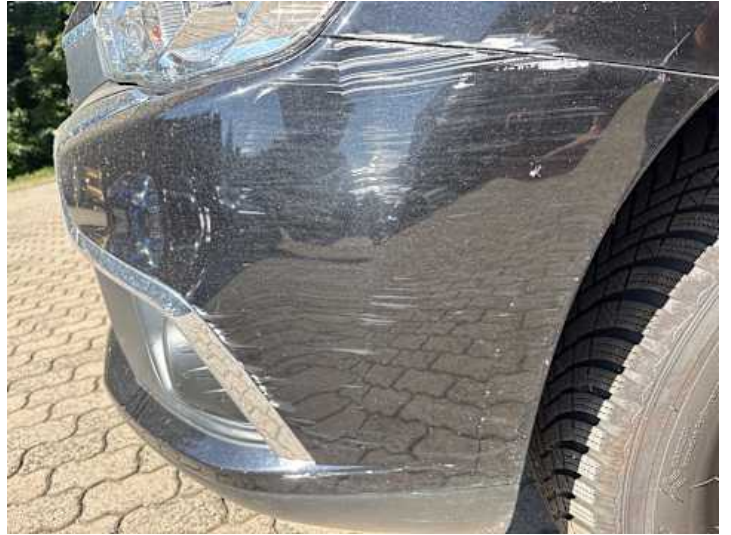
Stoßstange vorne (Kratzer, Lackschaden)
