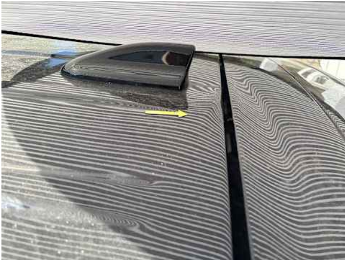
Dach (Verformung, Lackschaden)
