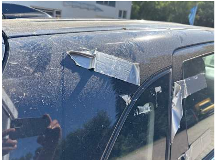
Seitenteil hinten rechts (Anderer Schaden): Kleberückstände
