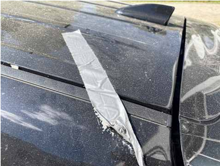
Dach (Anderer Schaden): Kleberückstände
