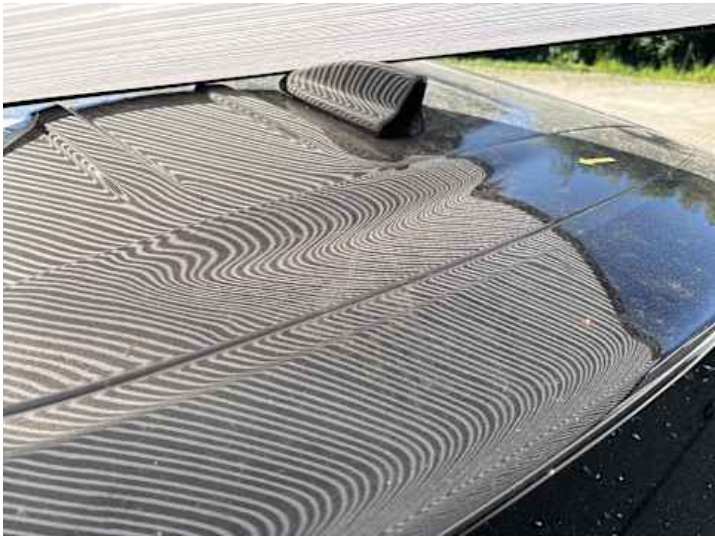
Heckklappe (Verformung, Lackschaden)
