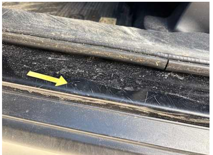
Schweller links (Kratzer, Delle)
