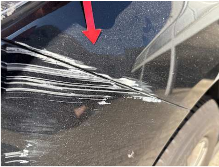
Kotflügel vorne links (Kratzer, Lackschaden)
