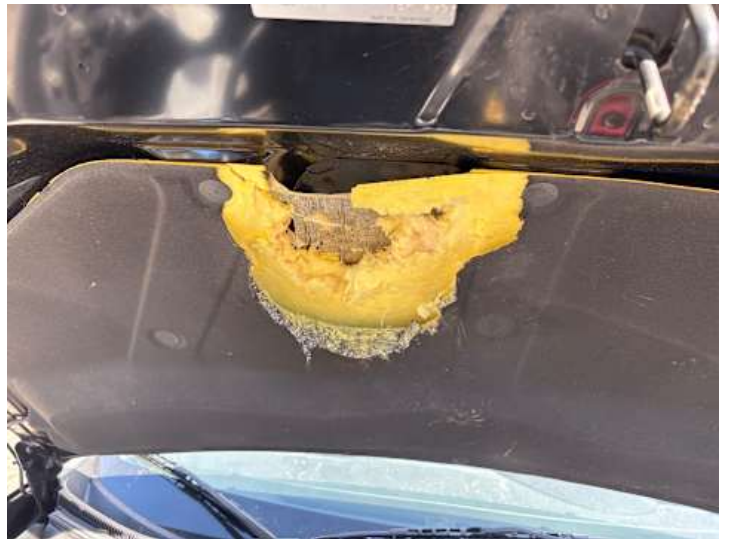
Motorhaube (Anderer Schaden): Dämmmatte beschädigt
