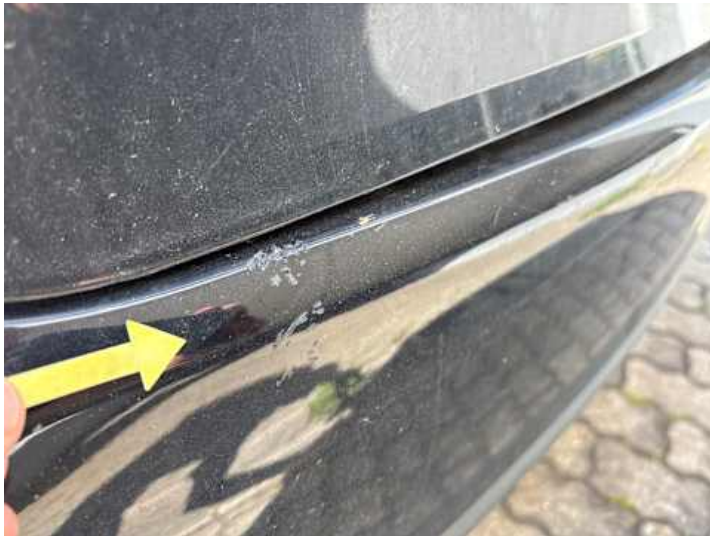
Stoßstange hinten (Kratzer, Lackschaden)
