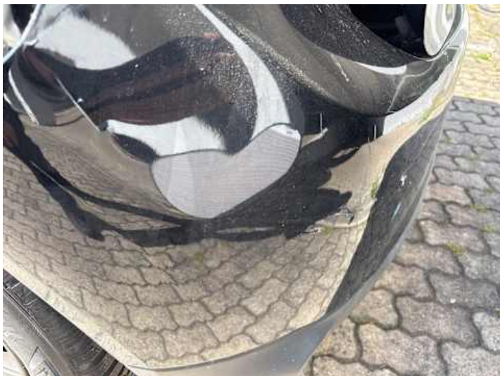
Stoßstange hinten (Verformung, Lackschaden)
