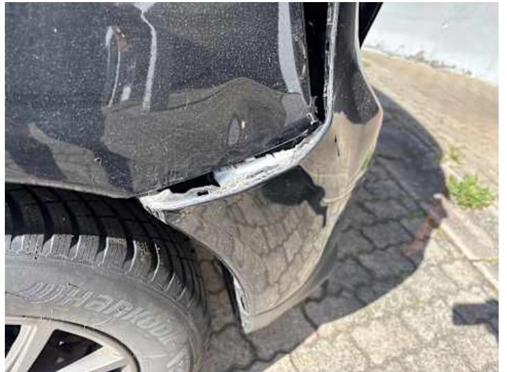
Stoßstange hinten (Verformung, Lackschaden)
