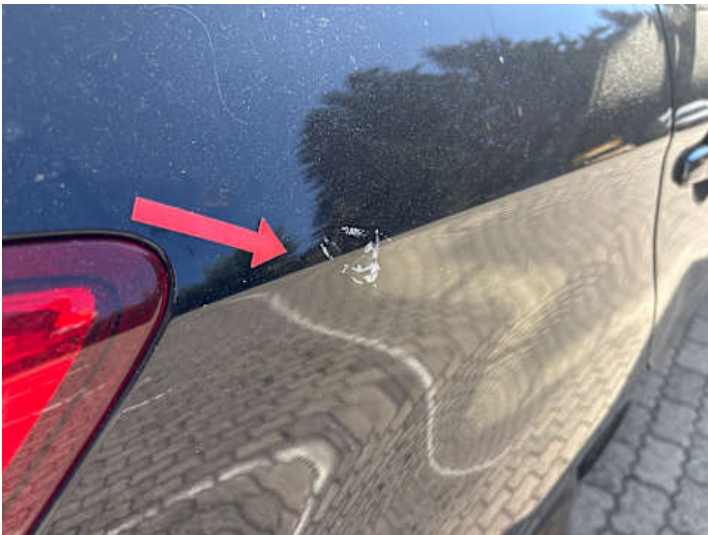
Seitenteil hinten rechts (Anderer Schaden): Kleberückstände
