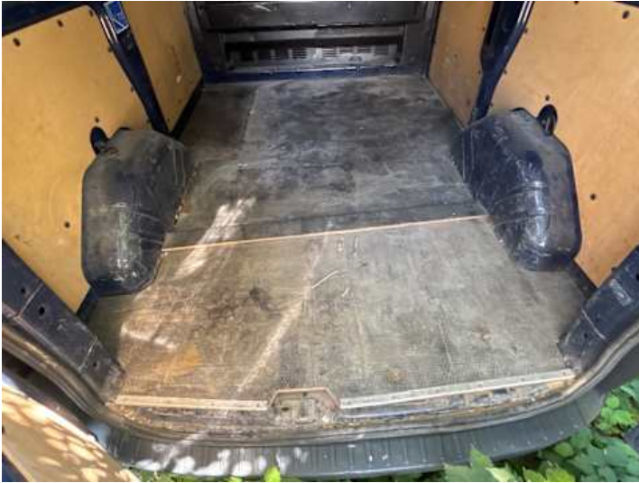
Innenraum (Kratzer, Verschleiß, Verschmutzung, Riss/Bruch)
