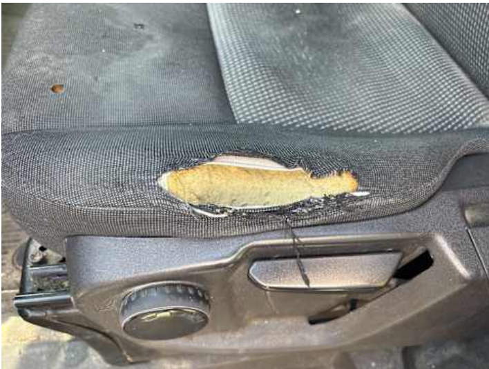
Innenraum (Riss/Bruch, Verschleiß)
