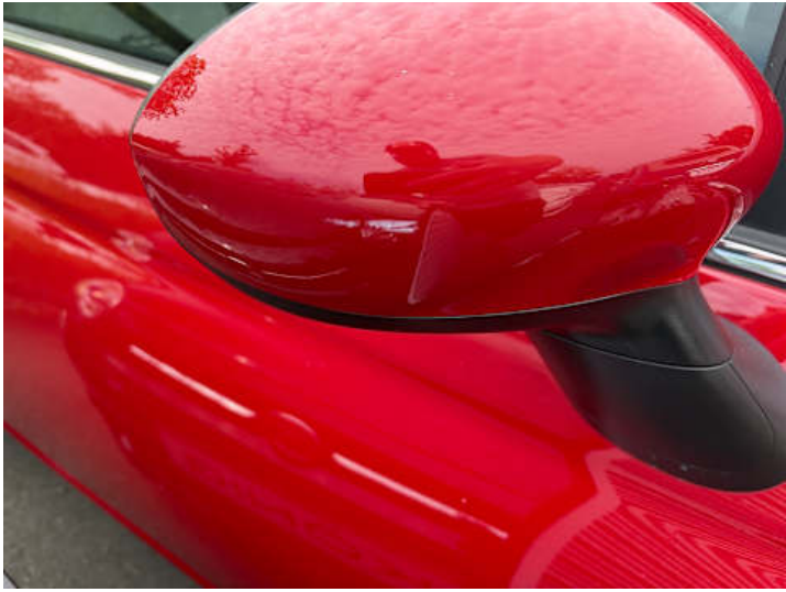
Beifahrtür (Kratzer, Lackschaden)
