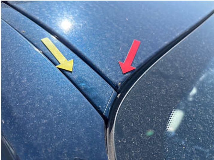
Dach (Rost, Lackschaden)
