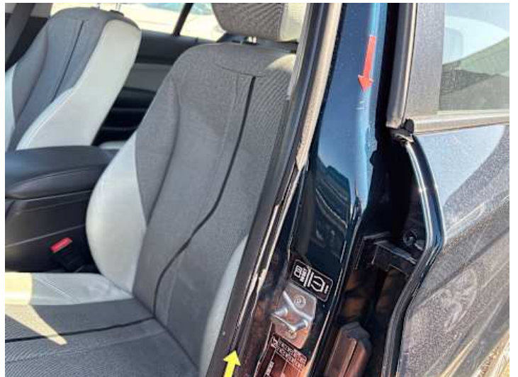
Fahrertür (Lackschaden, Riss/Bruch)
