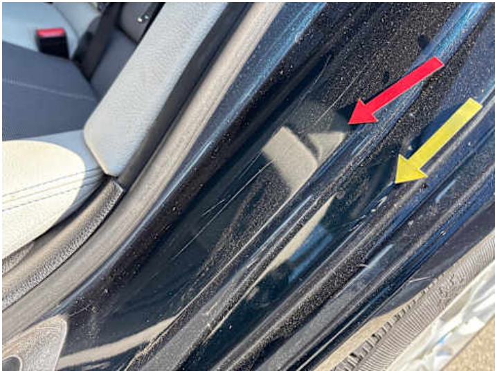
Türe hinten links (Kratzer)
