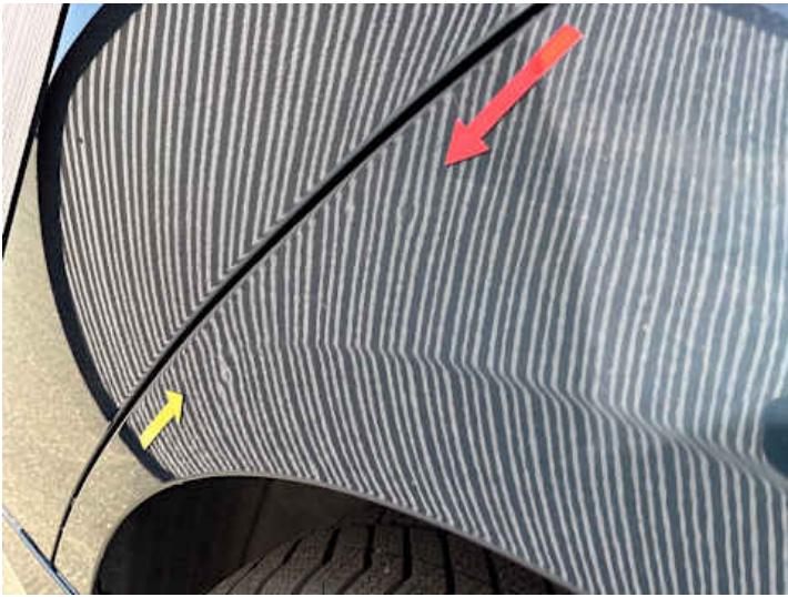
Seitenteil hinten links (Delle)
