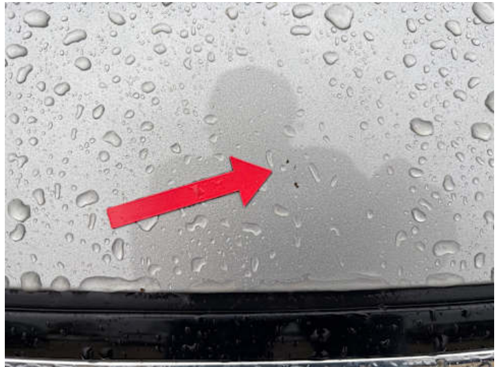
Motorhaube (Steinschlag, Rost)
