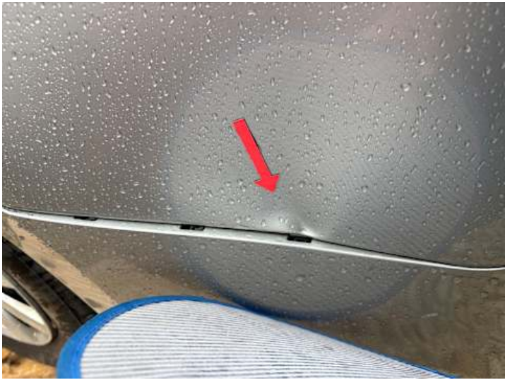
Seitenteil hinten links (Verformung, Delle)
