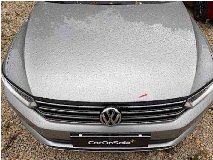
Motorhaube (Steinschlag, Rost)
