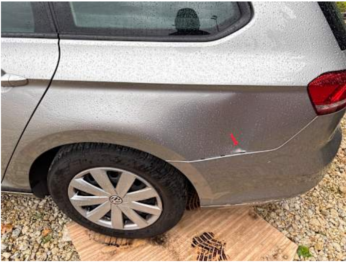
Seitenteil hinten links (Verformung, Delle)
