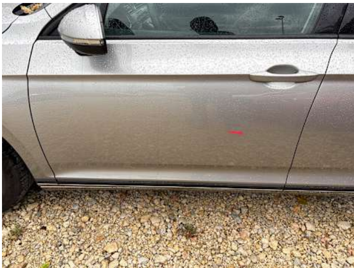
Fahrtür (Delle, Kratzer)
