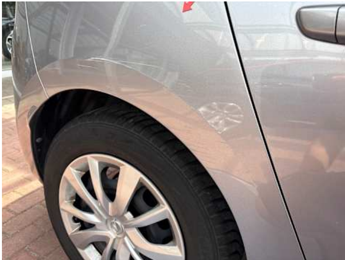
Seitenteil hinten rechts (Kratzer, Verformung)
