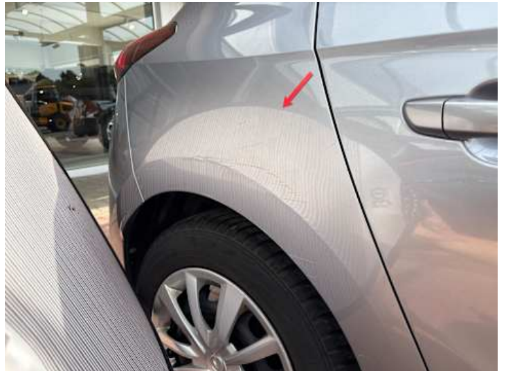
Seitenteil hinten rechts (Kratzer, Verformung)
