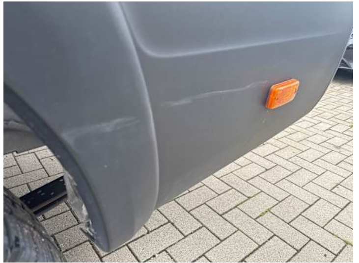
Seitenteil hinten links (Lackschaden, Verformung)
