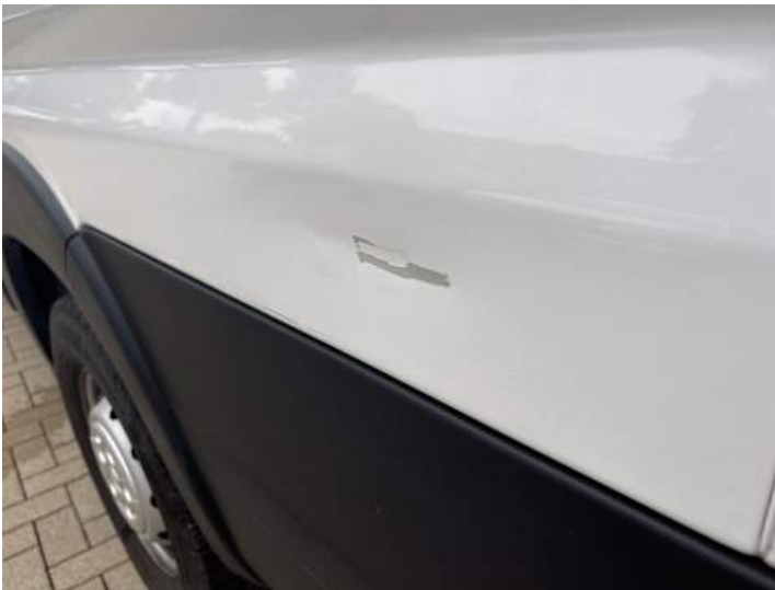
Seitenteil hinten links (Lackschaden, Verformung)
