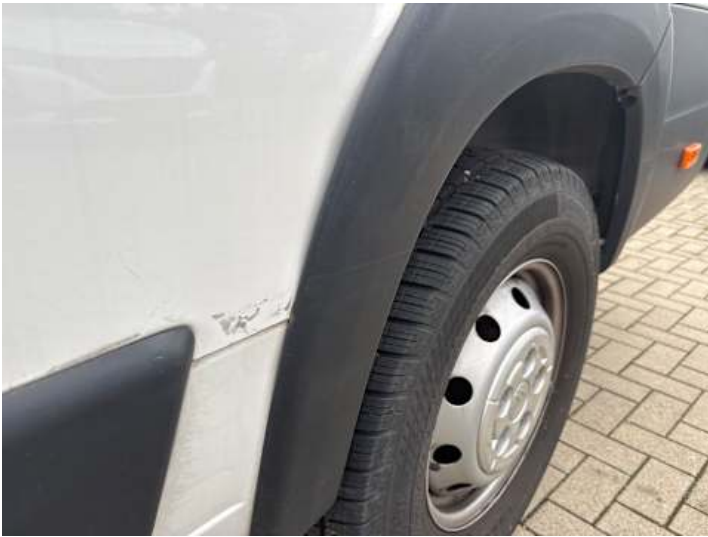
Seitenteil hinten links (Lackschaden, Verformung)
