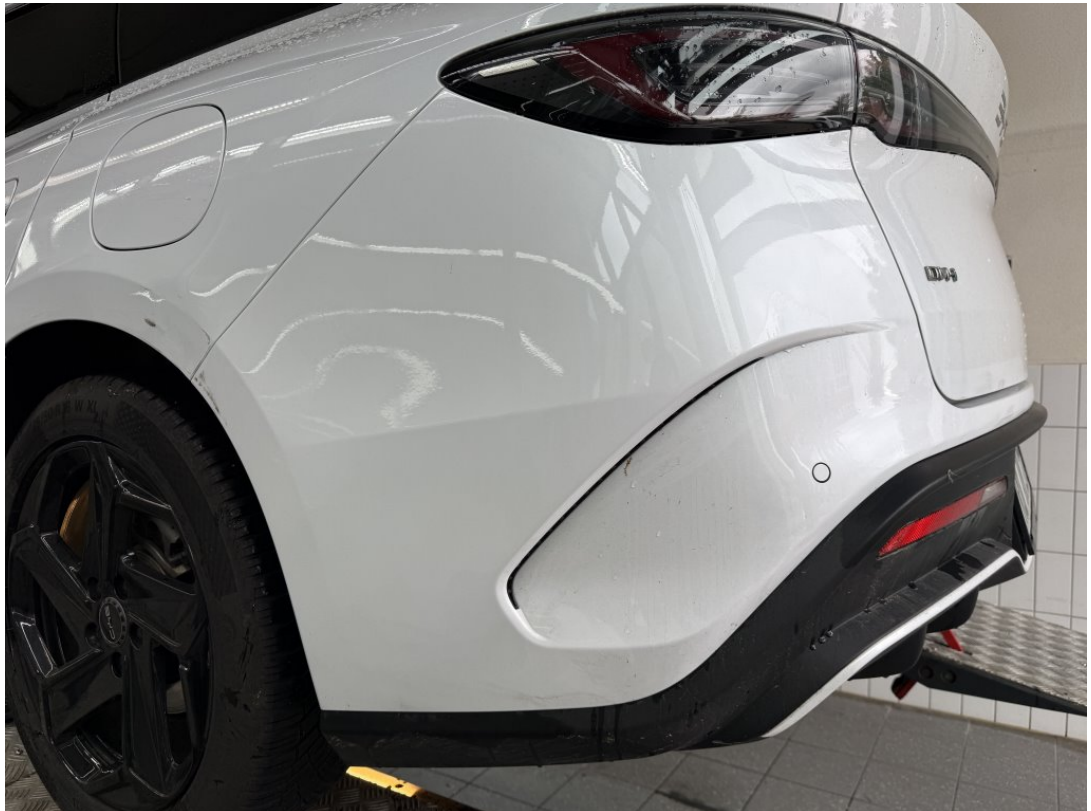
Verkleidung-Stoßfänger hinten beschädigt/plastisch verformt
