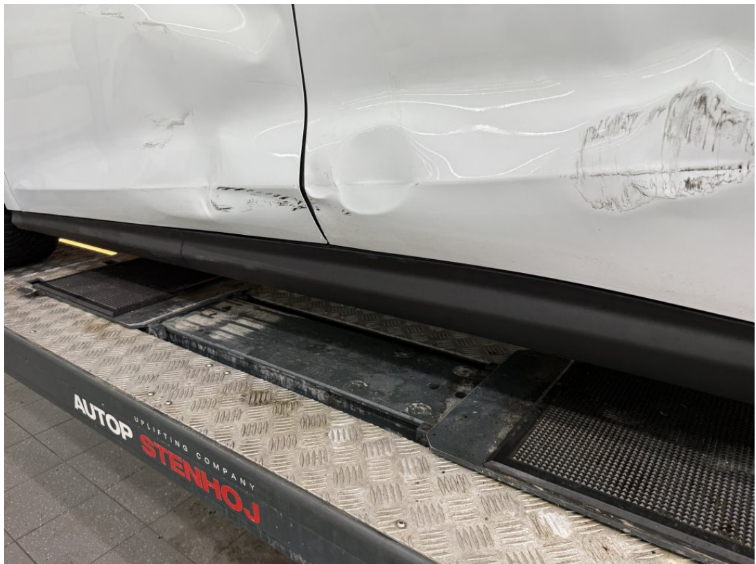
Schwellerblende links beschädigt/verschrammt
