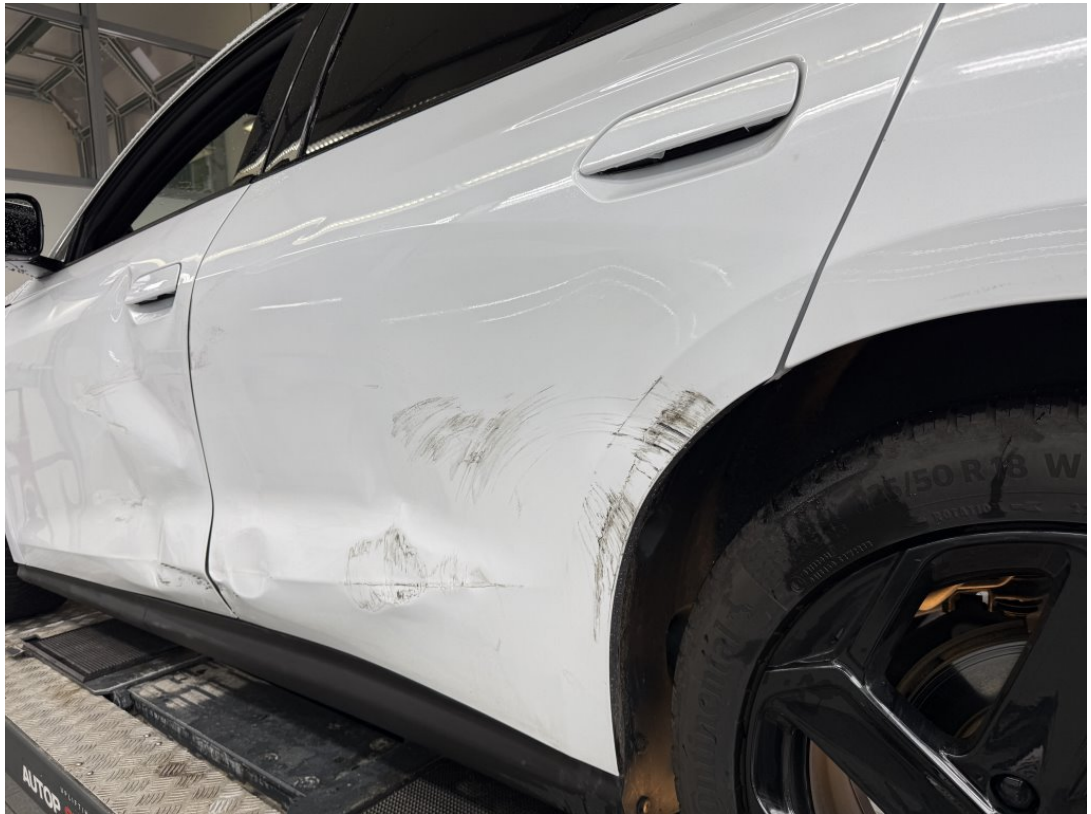
Tür hinten links beschädigt/deformiert
