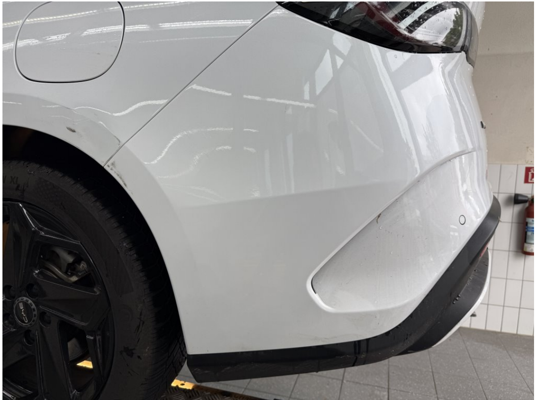
Verkleidung-Stoßfänger hinten beschädigt/plastisch verformt
