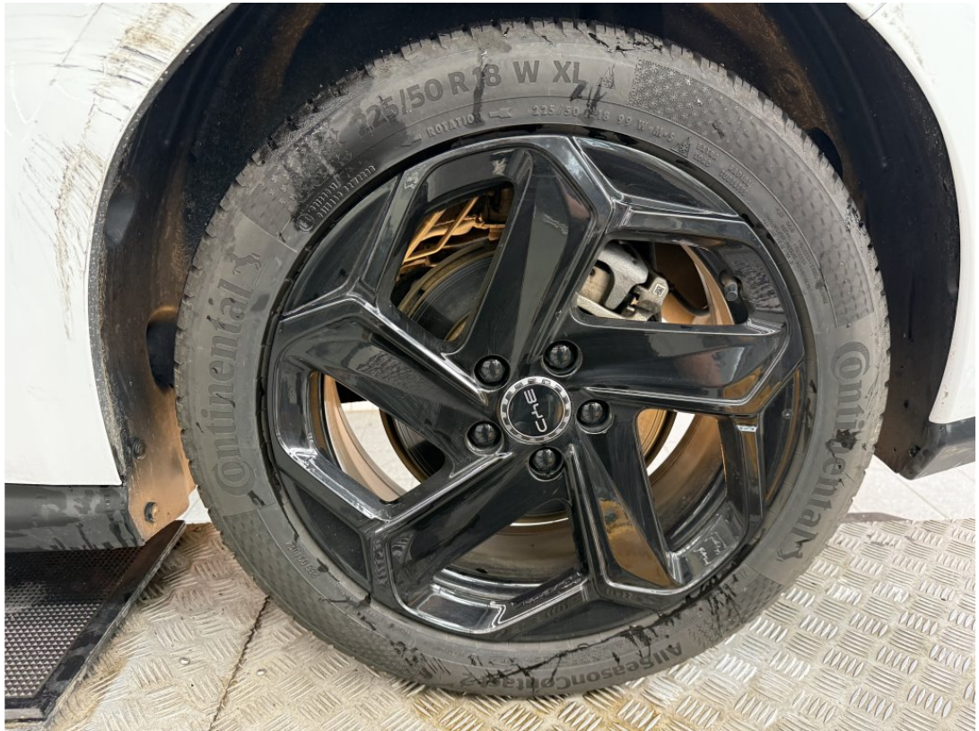
Felge hinten links beschädigt (Materialabtrag)
