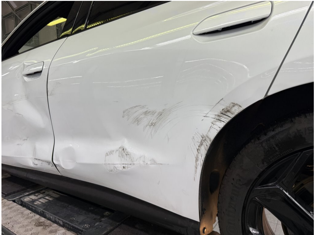
Tür hinten links beschädigt/deformiert
