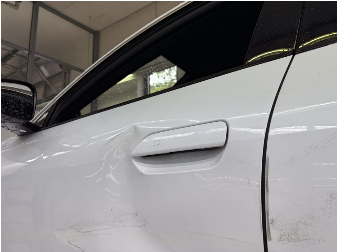
Türgriff vorne links beschädigt
