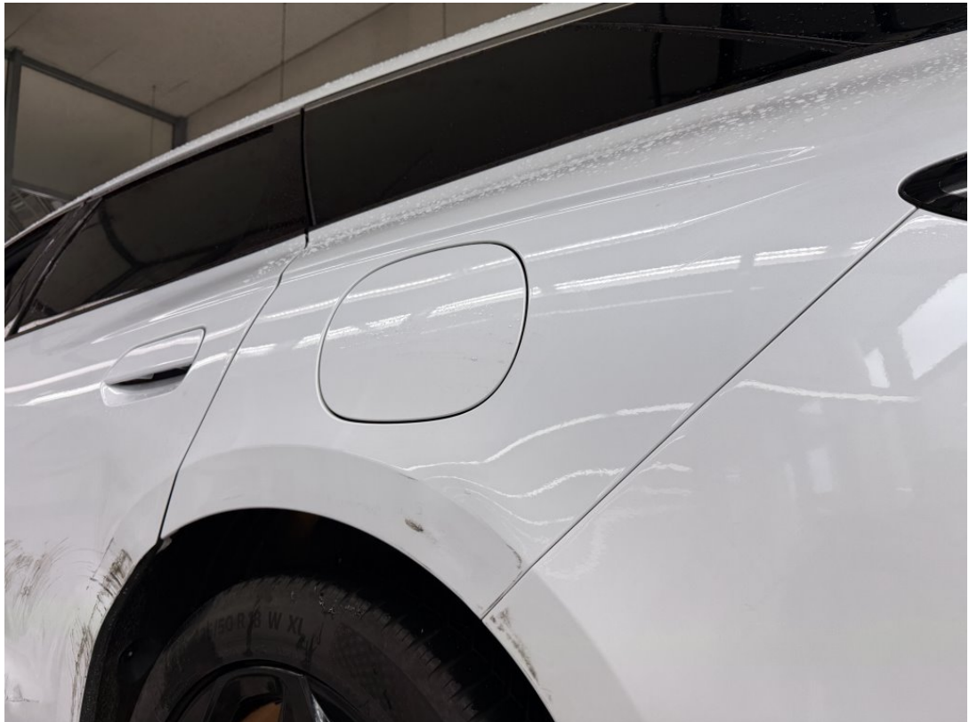
Seitenwand hinten links beschädigt/deformiert
