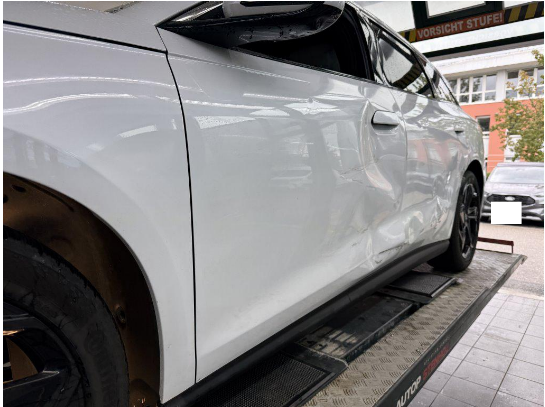
Tür vorne links beschädigt/deformiert
