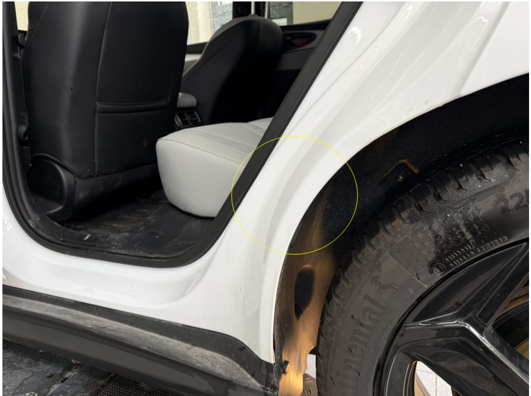
Seitenwand hinten links beschädigt/deformiert
