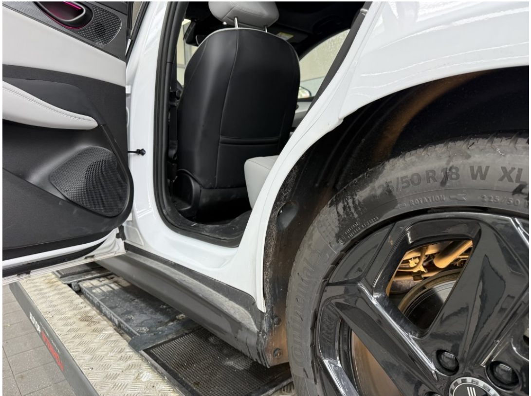
Seitenwand hinten links beschädigt/deformiert
