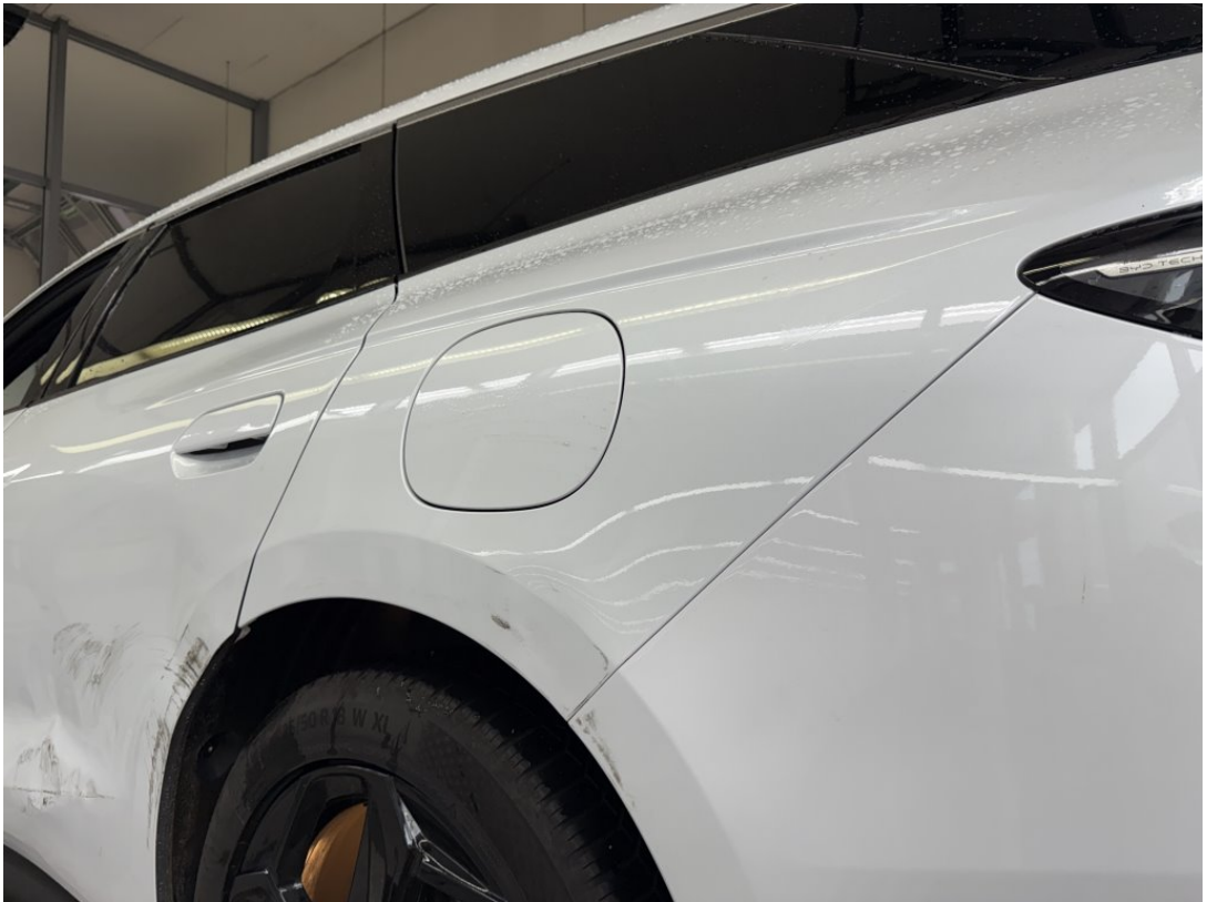
Seitenwand hinten links beschädigt/deformiert
