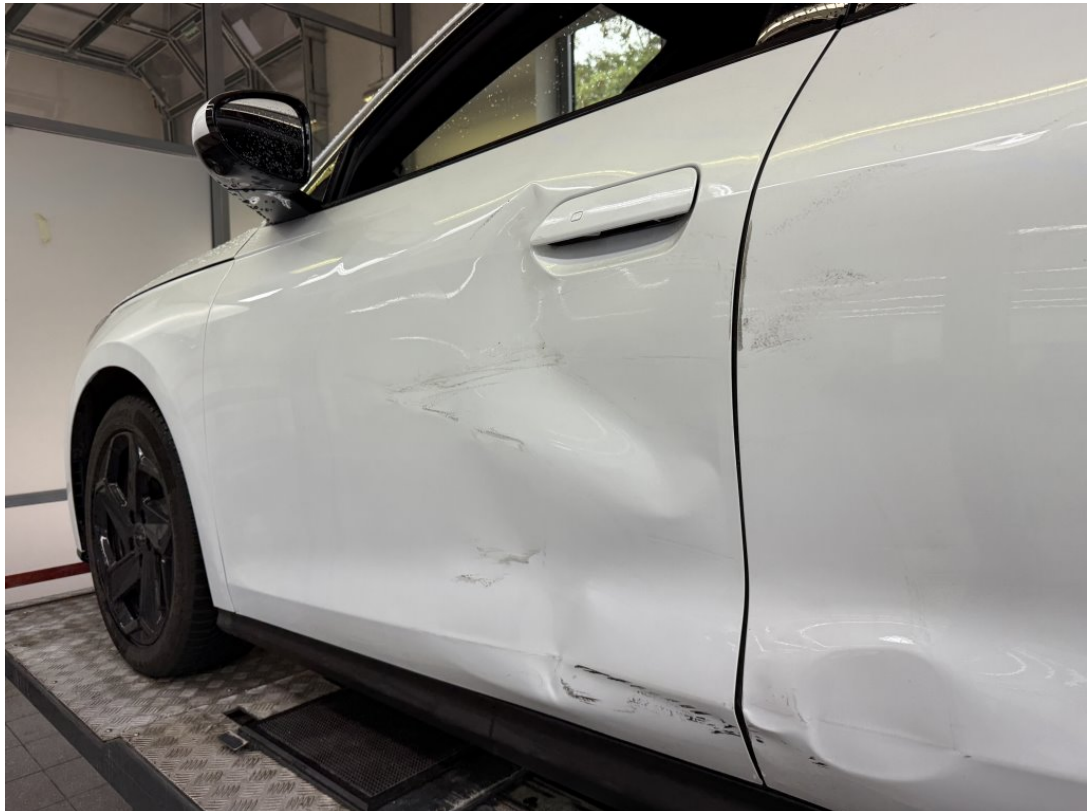
Tür vorne links beschädigt/deformiert
