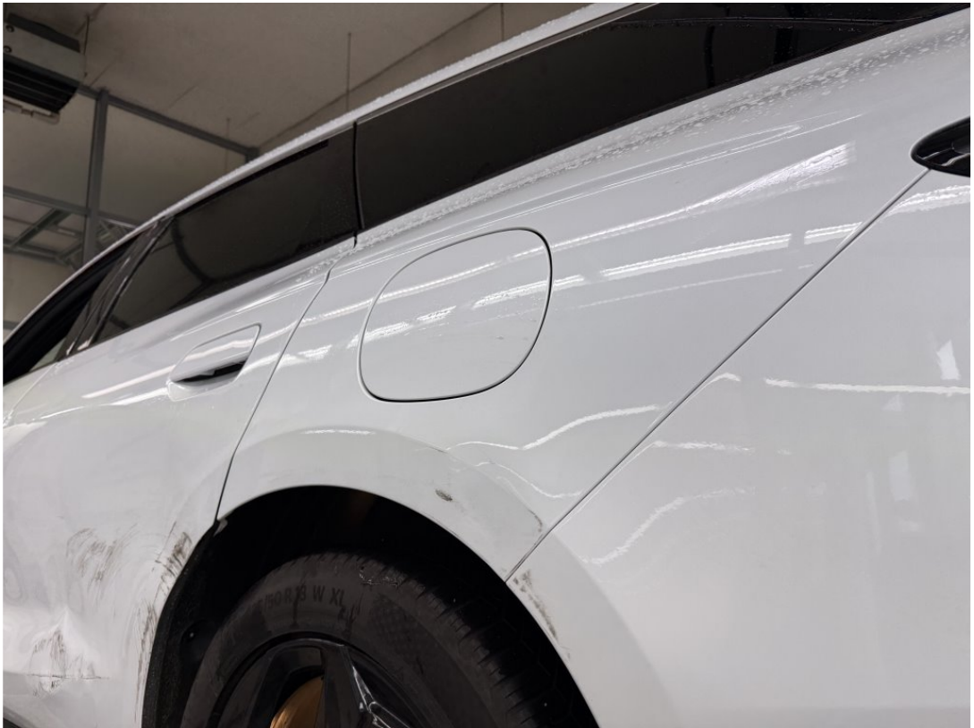
Seitenwand hinten links beschädigt/deformiert
