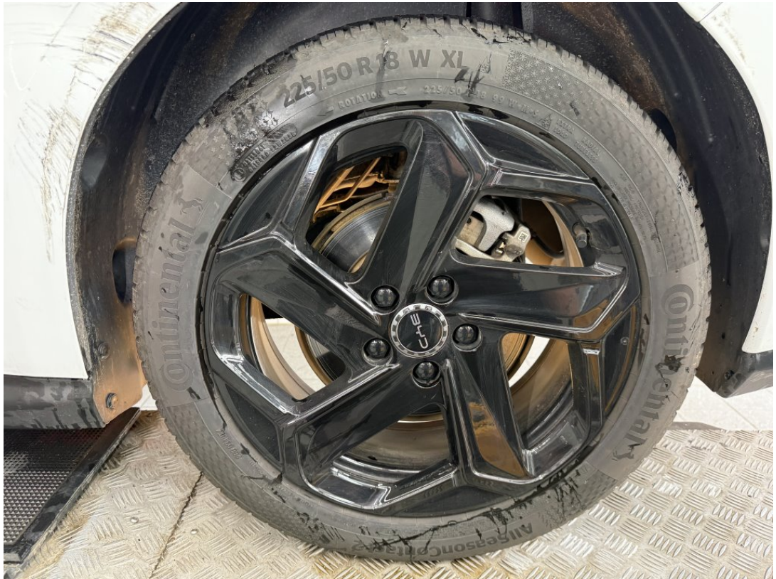
Reifen hinten links (Reifenwand) beschädigt
