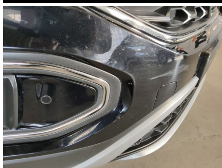
Stoßfänger / Vorne Rechts / Kratzer
