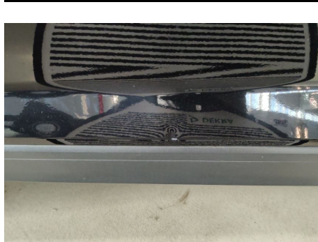
Tür / Vorne Links / Delle
