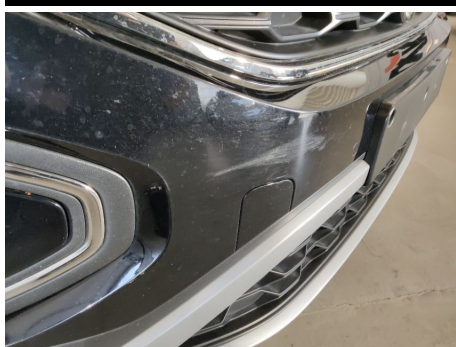
Stoßfänger / Vorne Rechts / Kratzer
