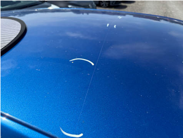
Dach (Delle, Kratzer)
