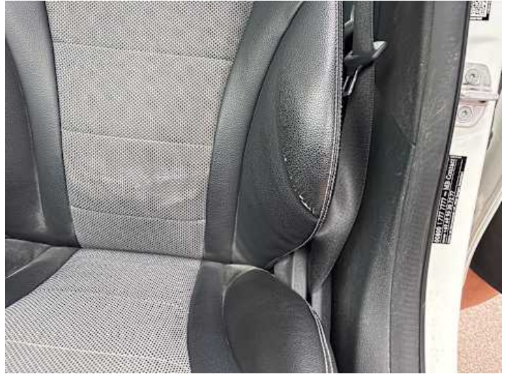
Innenraum (Verschleiß, Riss/Bruch)
