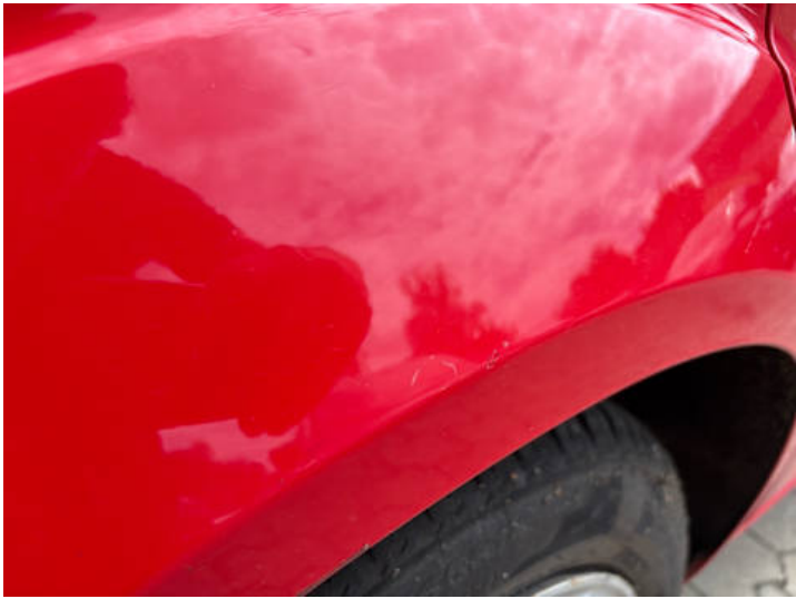
Seitenteil hinten rechts (Lackschaden)
