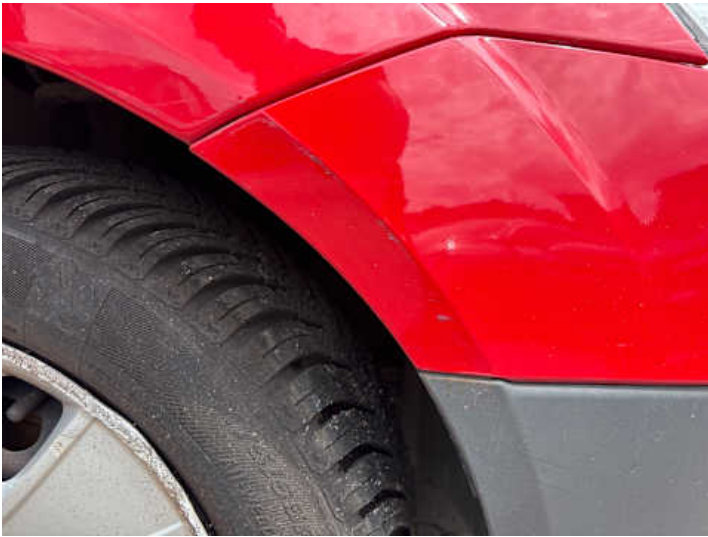
Stoßstange vorne (Lackschaden, Kratzer)
