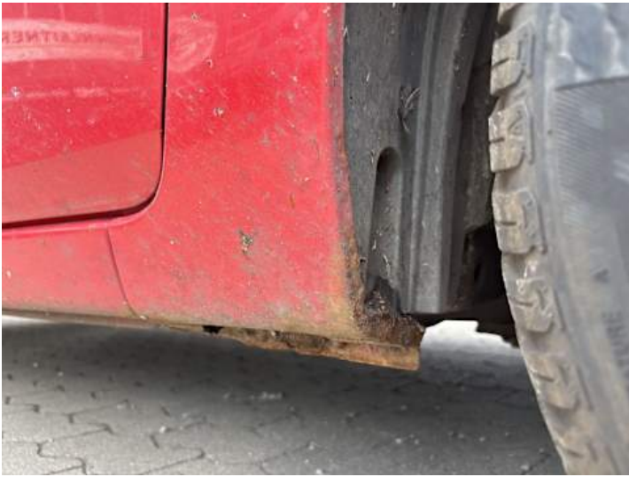
Kotflügel vorne rechts (Rost)
