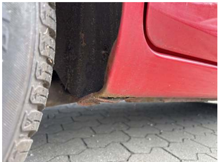
Schweller rechts (Rost)
