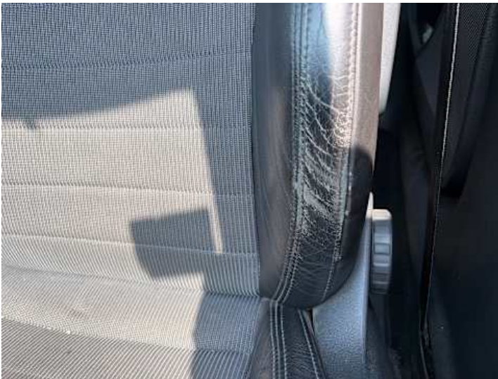
Innenraum (Verschleiß, Riss/Bruch)
