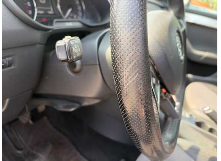
Innenraum (Verschleiß, Riss/Bruch)
