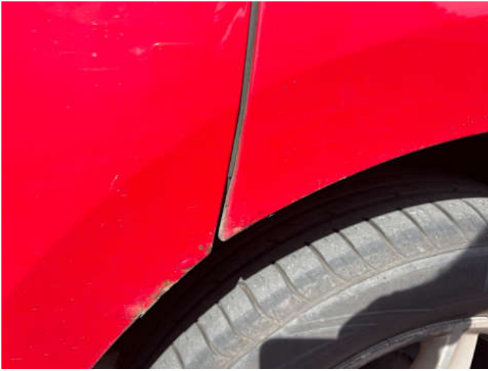
Seitenteil hinten links (Rost)
