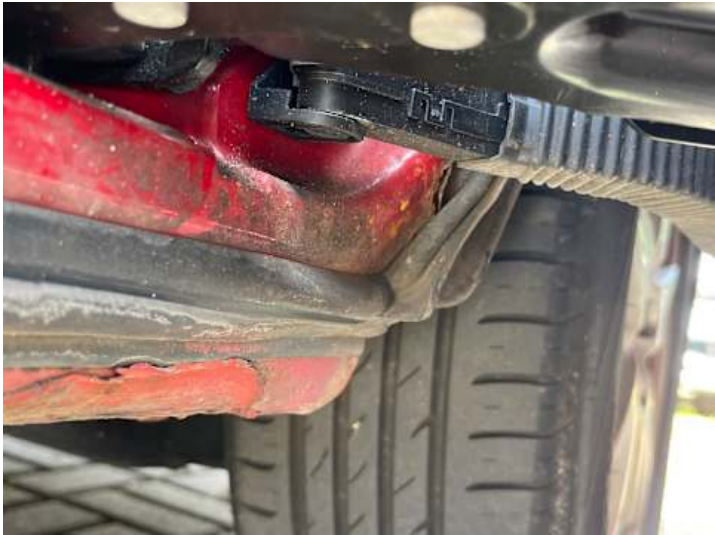
Schweller links (Rost)
