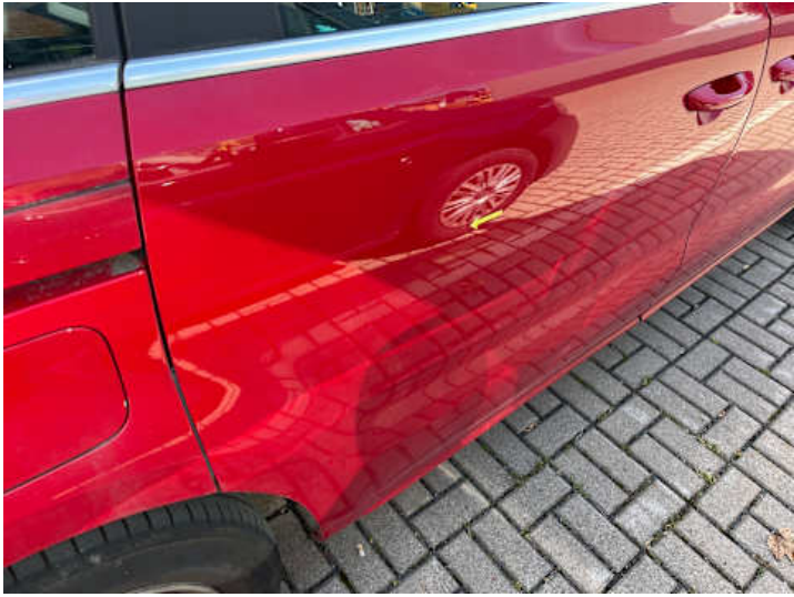
Türe hinten rechts (Lackschaden, Rost)
