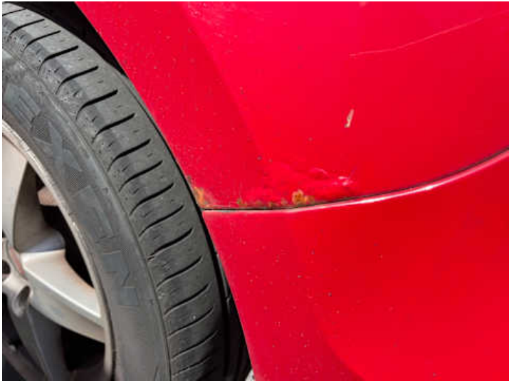
Seitenteil hinten links (Rost)
