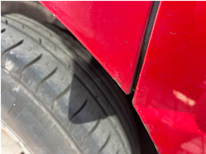
Seitenteil hinten rechts (Rost)
