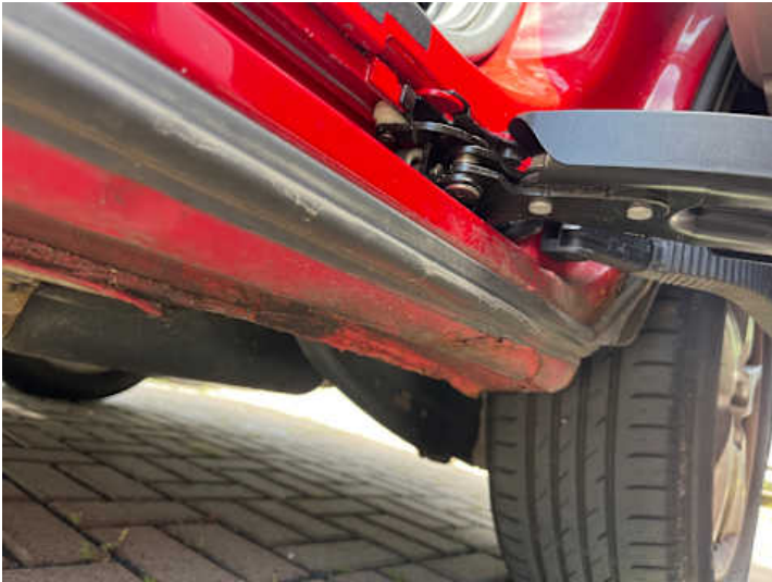
Schweller links (Rost)
