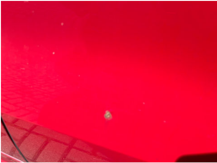
Türe hinten links (Rost)
