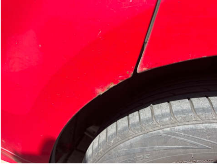
Türe hinten links (Rost)
