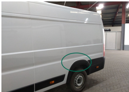
Seitenwand / Hinten Links / Schlecht Repariert
