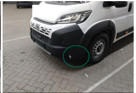
Stoßfänger / Vorne Links / Kratzer
