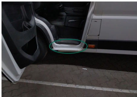
Türeinstieg / Vorne Links / Abgewetzt
