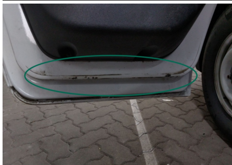
Tür / Innenraum Vorne Links / Abgewetzt
