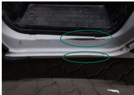
Türeinstieg / Vorne Links / Abgewetzt
