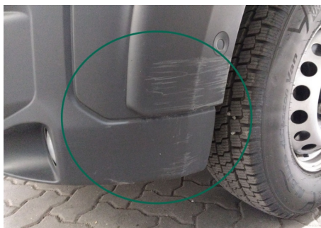
Stoßfänger / Vorne Links / Kratzer
