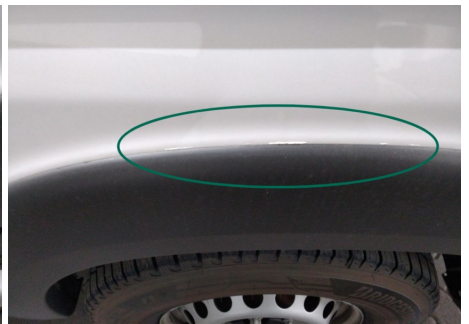
Seitenwand / Hinten Links / Schlecht Repariert
