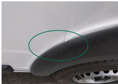
Seitenwand / Hinten Links / Schlecht Repariert
