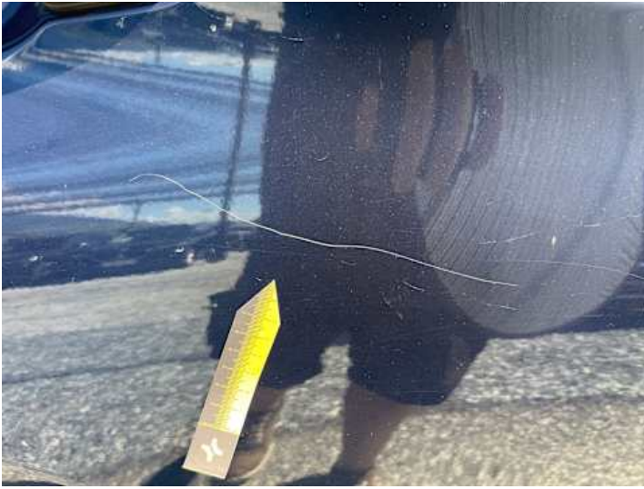
Türe hinten rechts (Kratzer, Lackschaden)
