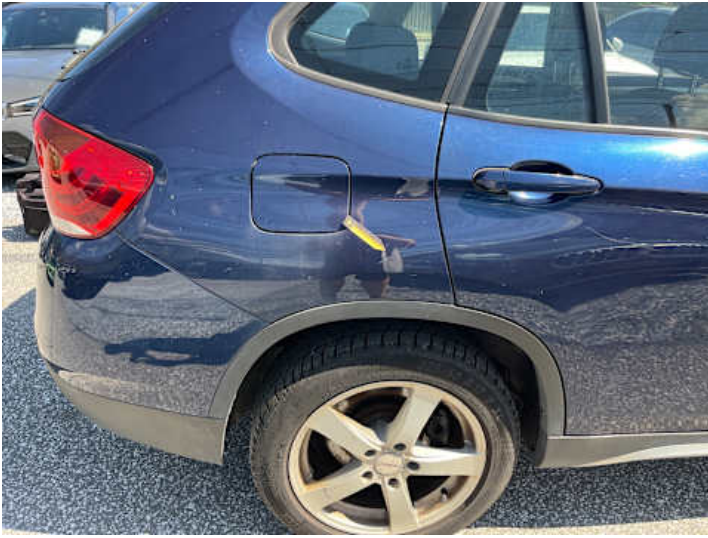
Seitenteil hinten rechts (Kratzer, Lackschaden)
