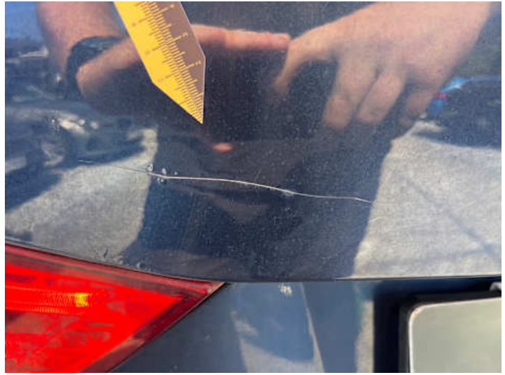
Heckklappe (Kratzer, Lackschaden)
