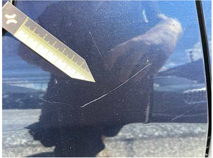
Seitenteil hinten rechts (Kratzer, Lackschaden)
