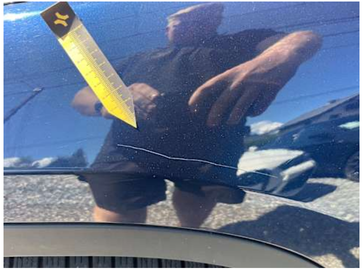
Kotflügel vorne links (Kratzer, Lackschaden)
