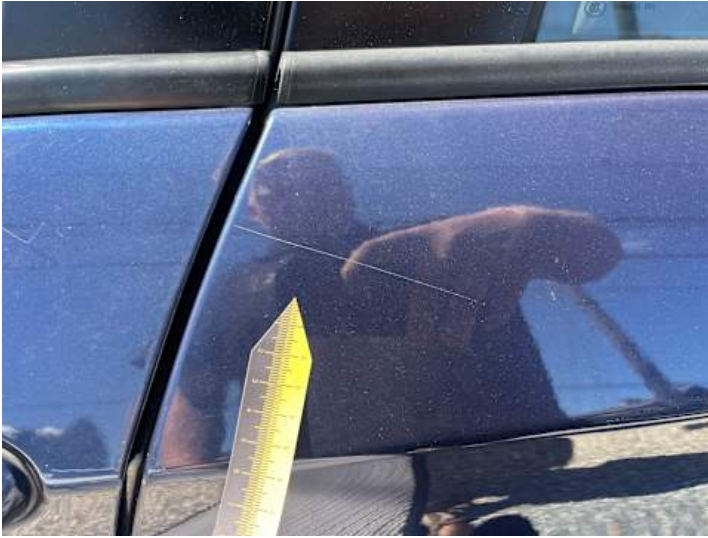
Türe hinten links (Kratzer, Lackschaden)
