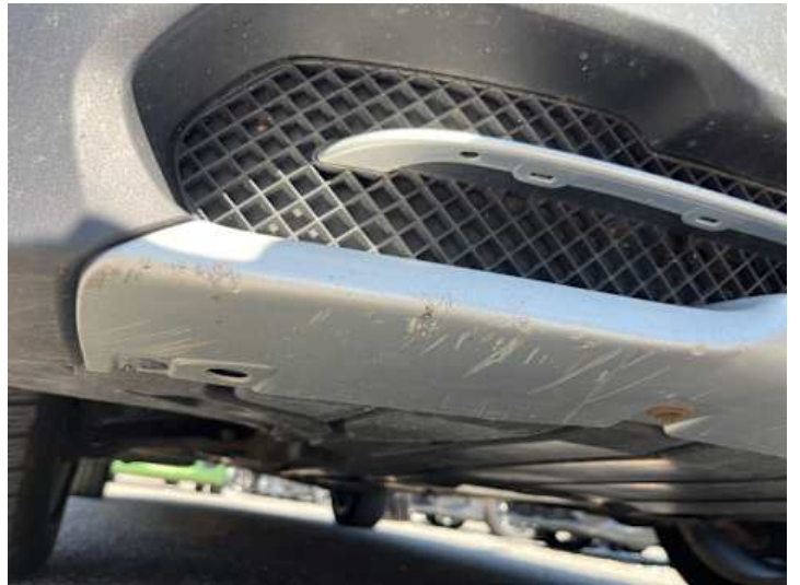
Stoßstange vorne (Kratzer, Spaltmaße ungenau, Riss/Bruch)
