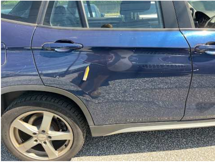
Türe hinten rechts (Kratzer, Lackschaden)
