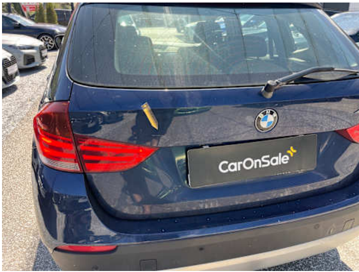
Heckklappe (Kratzer, Lackschaden)
