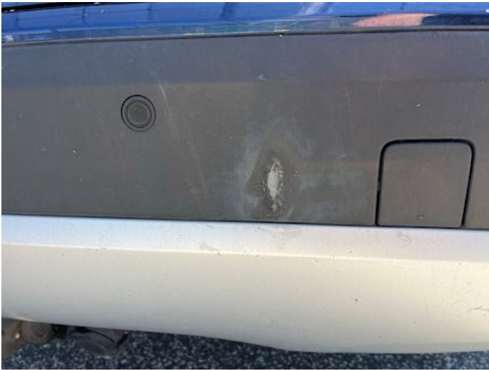
Stoßstange hinten (Kratzer, Lackschaden)
