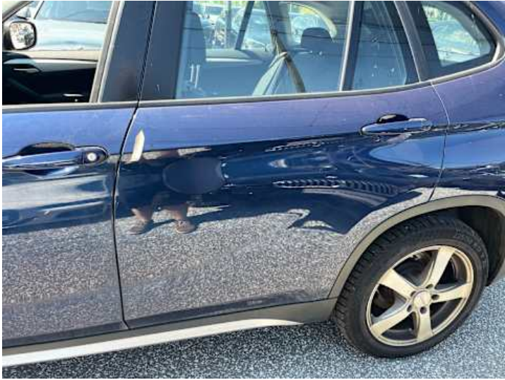
Türe hinten links (Kratzer, Lackschaden)
