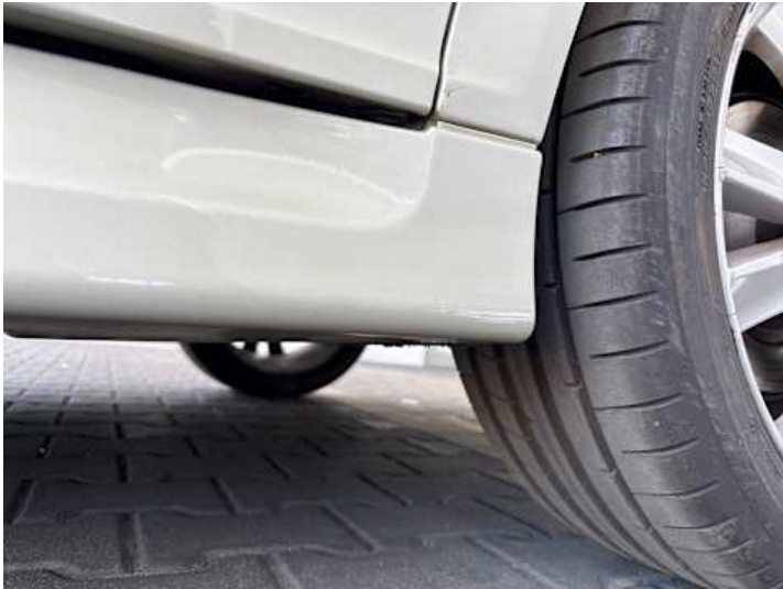
Schweller links (Verformung, Kratzer)
