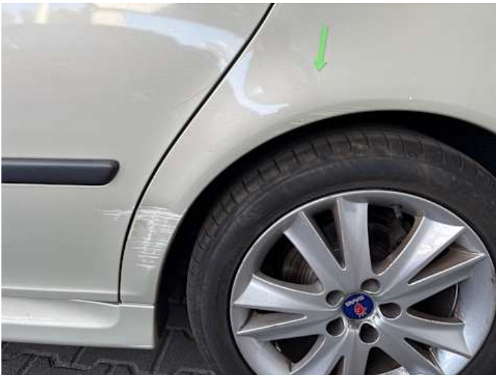
Seitenteil hinten links (Kratzer, Verformung)
