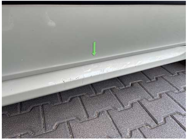
Schweller rechts (Verformung, Riss/Bruch, Kratzer)
