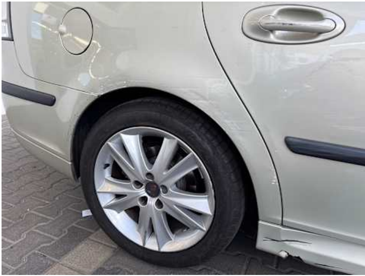
Seitenteil hinten rechts (Kratzer, Delle, Verformung)
