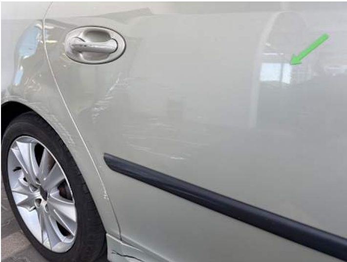
Türe hinten rechts (Kratzer, Verformung)
