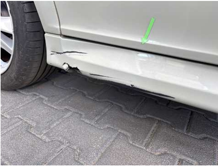
Schweller rechts (Verformung, Riss/Bruch, Kratzer)
