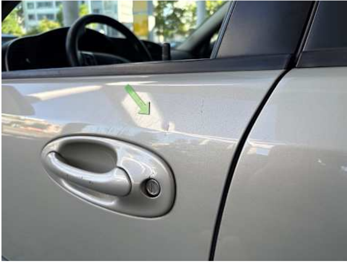
Fahrtür (Delle, Kratzer)
