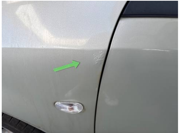
Kotflügel vorne links (Rost)
