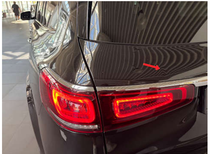
Heckklappe (Delle, Verformung)
