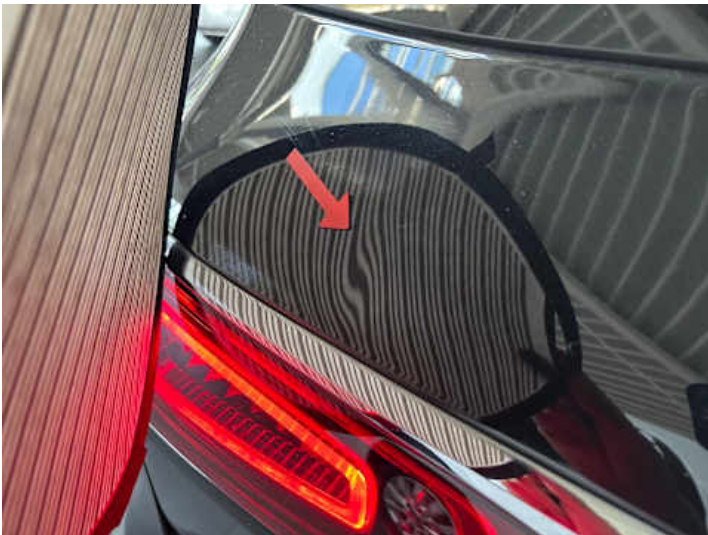
Heckklappe (Delle, Verformung)
