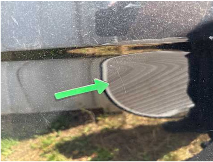
Türe hinten rechts (Kratzer, Delle)
