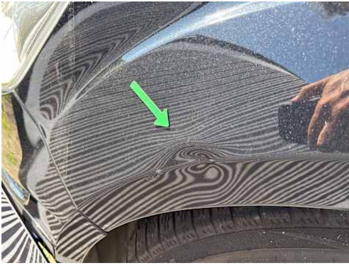
Kotflügel vorne links (Verformung, Kratzer)
