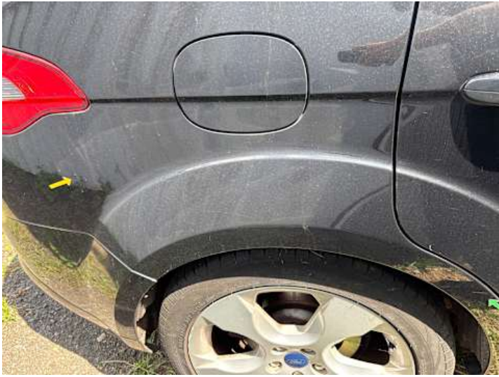
Seitenteil hinten rechts (Kratzer)
