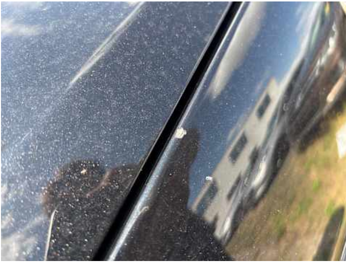
Kotflügel vorne links (Verformung, Kratzer)
