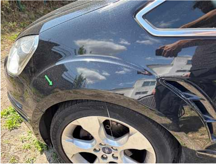
Kotflügel vorne links (Verformung, Kratzer)
