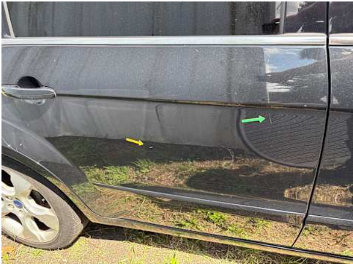
Türe hinten rechts (Kratzer, Delle)
