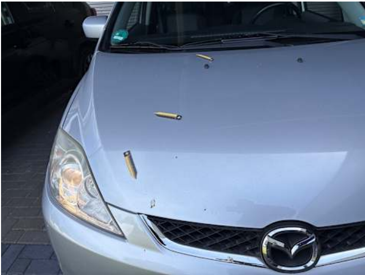
Motorhaube (Delle, Lackschaden, Kratzer)
