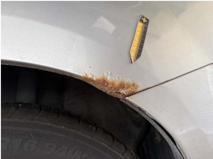
Seitenteil hinten links (Rost)
