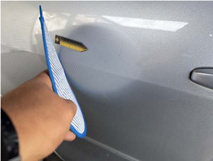
Türe hinten rechts (Kratzer, Delle)
