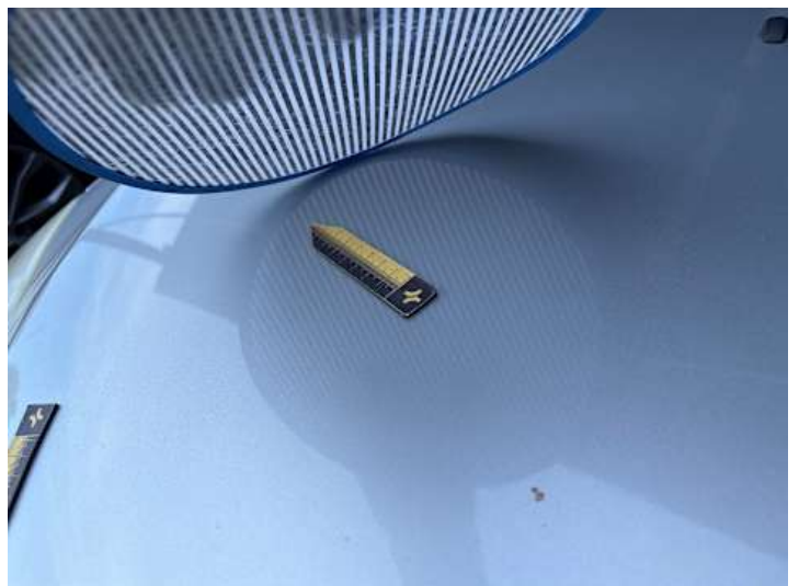
Motorhaube (Delle, Lackschaden, Kratzer)
