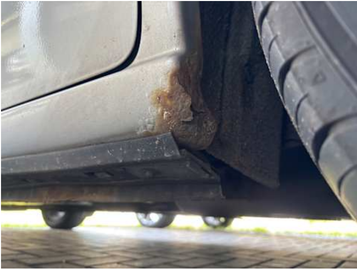
Schweller links (Rost)
