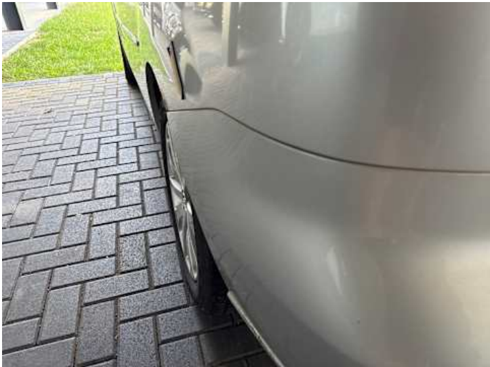
Stoßstange hinten (Lackschaden, Verformung)
