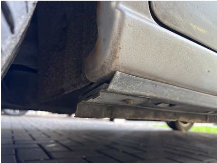
Schweller rechts (Rost)
