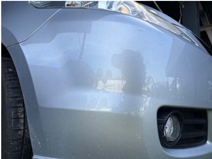
Stoßstange vorne (Kratzer, Lackschaden)
