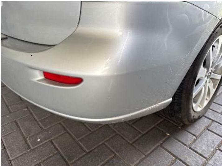
Stoßstange hinten (Lackschaden, Kratzer)
