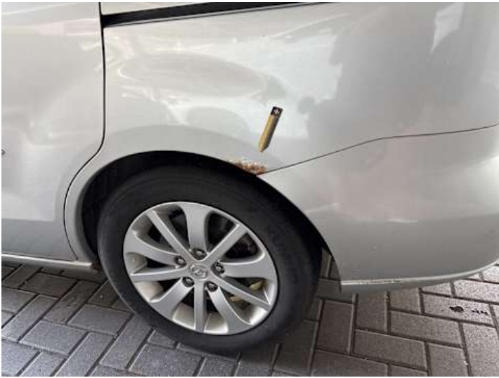
Seitenteil hinten links (Rost)
