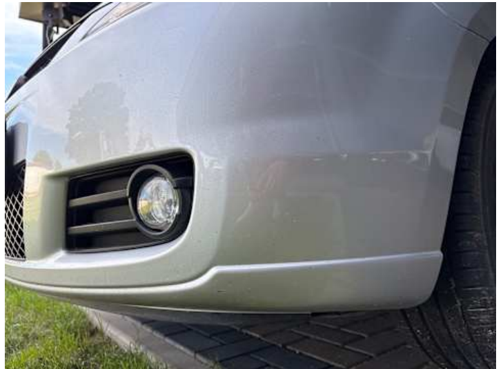
Stoßstange vorne (Kratzer, Lackschaden)
