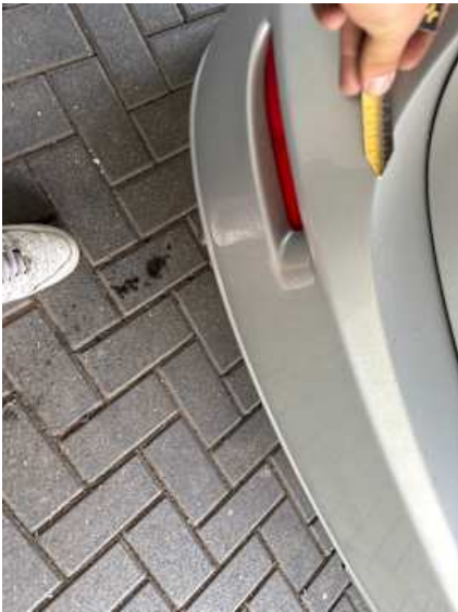
Stoßstange hinten (Lackschaden, Verformung)
