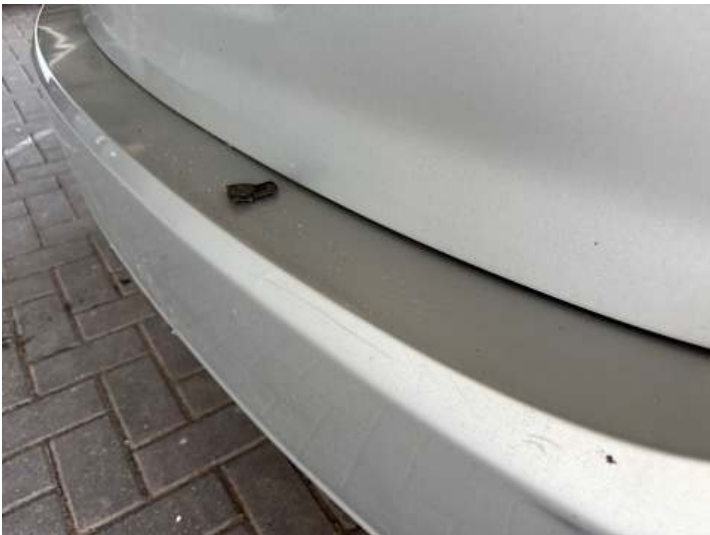
Stoßstange hinten (Lackschaden, Kratzer)
