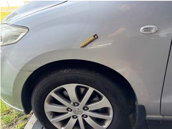
Kotflügel vorne links (Kratzer)
