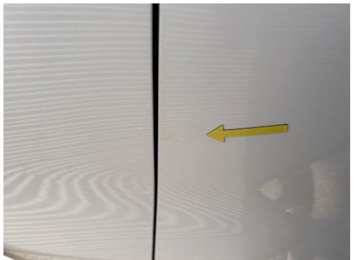
Türe hinten links (Delle)
