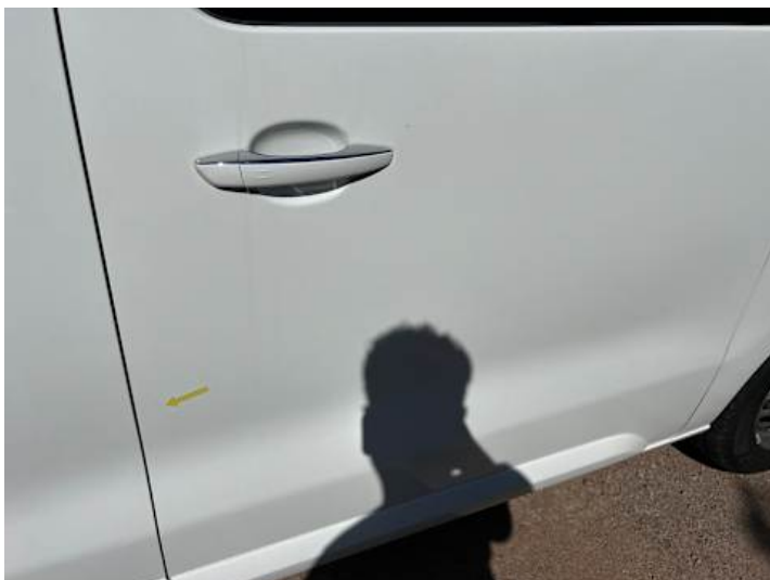
Türe hinten links (Delle)
