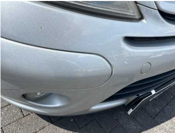
Stoßstange vorne (Kratzer)
