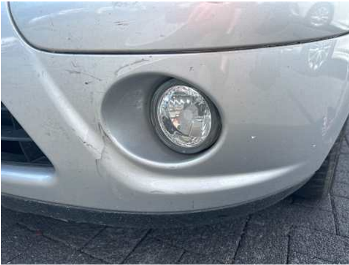
Stoßstange vorne (Riss/Bruch)
