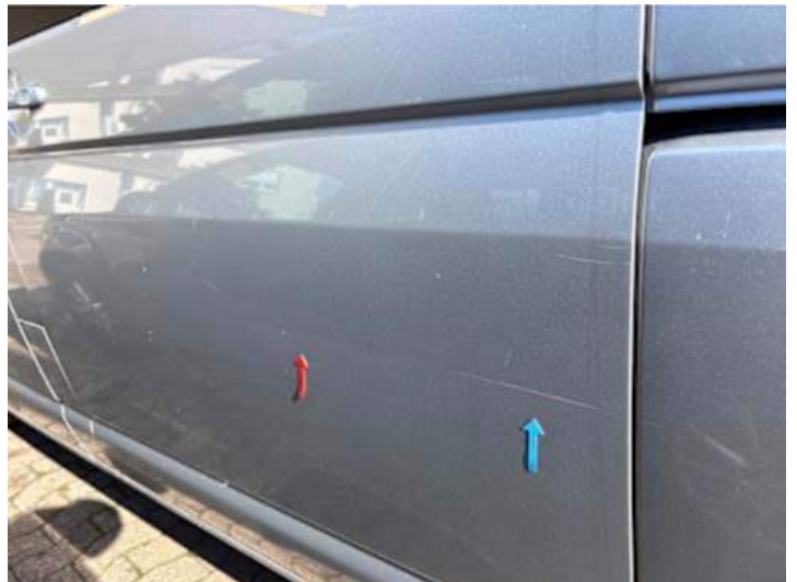
Türe hinten links (Kratzer, Verformung)
