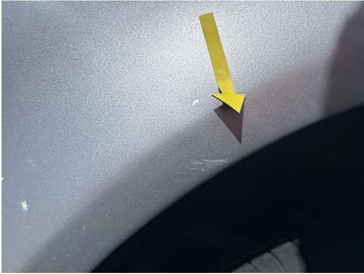
Seitenteil hinten rechts (Kratzer)
