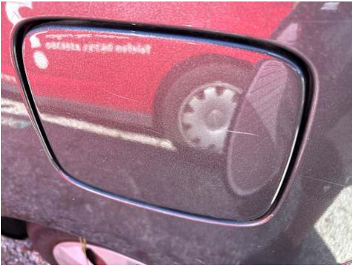
Seitenteil hinten links (Lackschaden, Kratzer)
