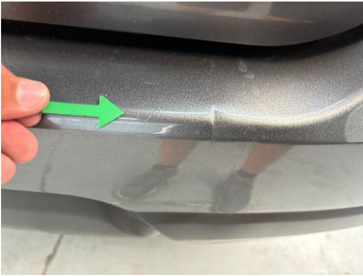
Stoßstange hinten (Kratzer, Verformung)
