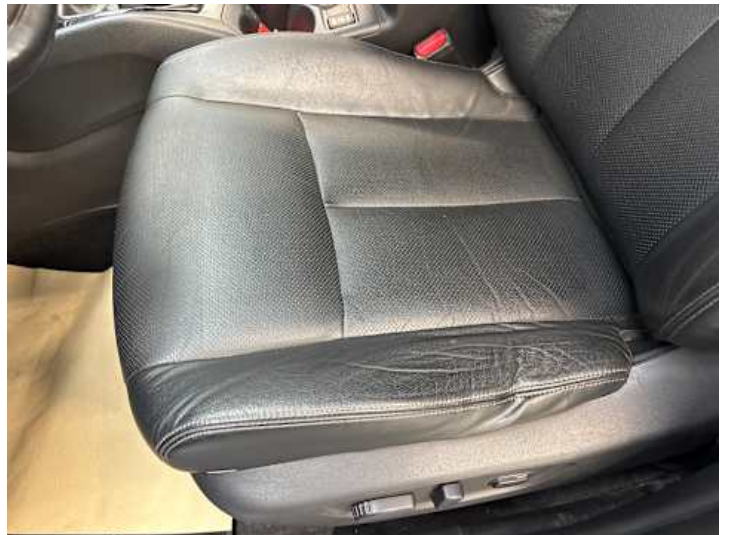
Innenraum (Verschmutzung, Verschleiß)
