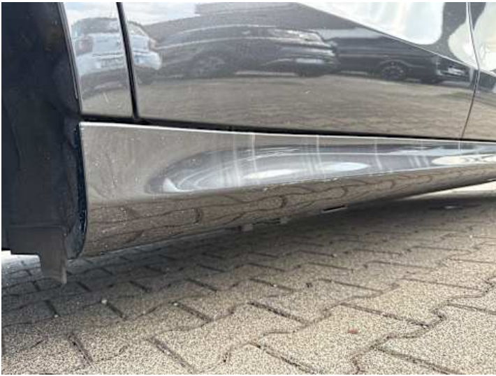
Schweller rechts (Kratzer, Lackschaden)
