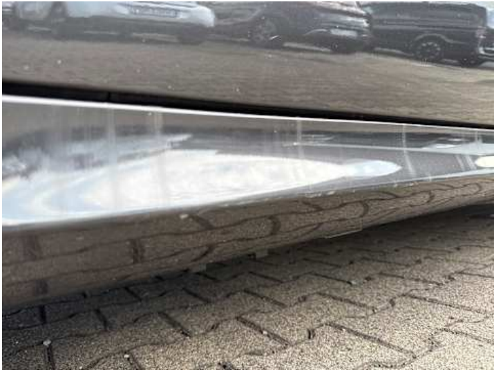
Schweller rechts (Kratzer, Lackschaden)
