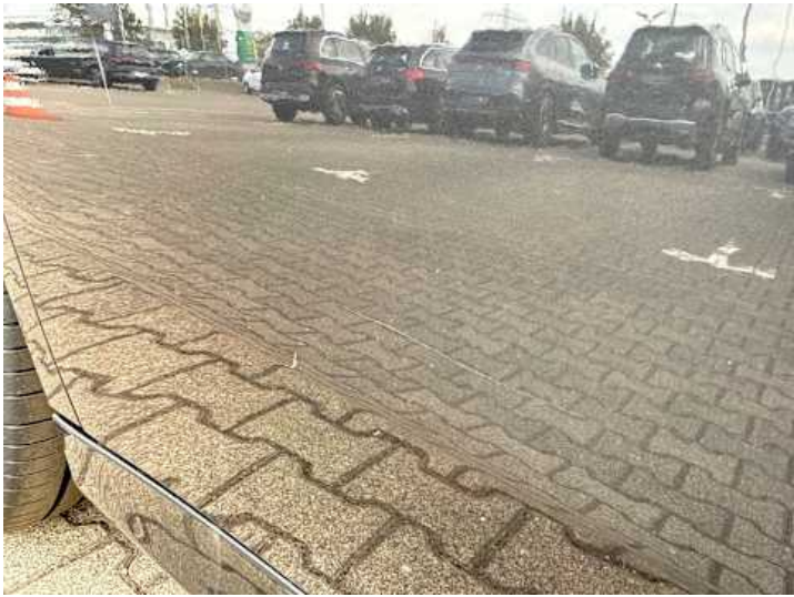
Türe hinten rechts (Kratzer, Lackschaden)
