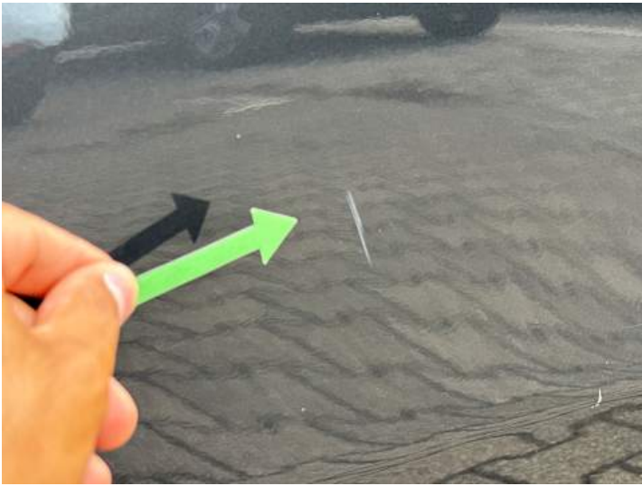
Türe hinten rechts (Kratzer, Lackschaden)
