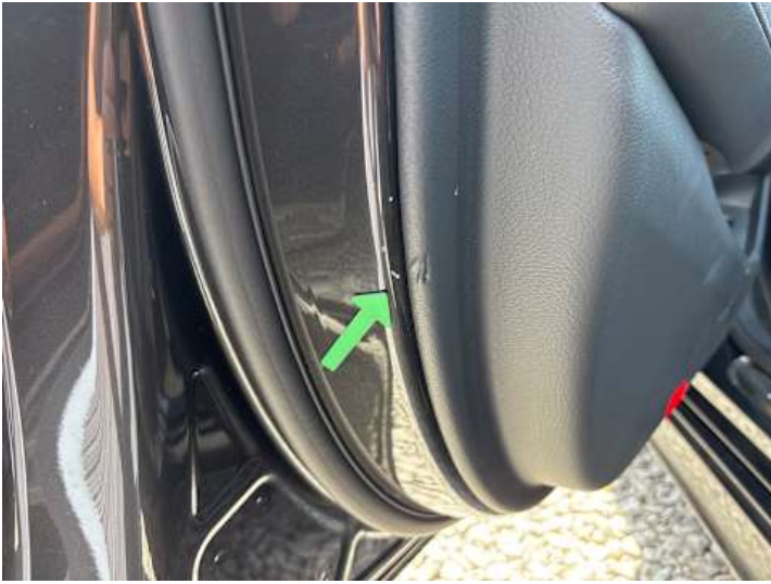
Fahrtür (Lackschaden, Kratzer)
