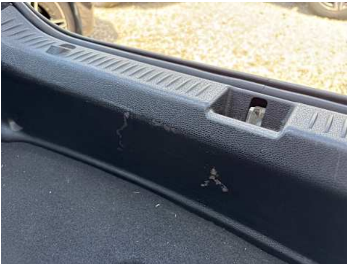
Innenraum (Verschmutzung, Kratzer)
