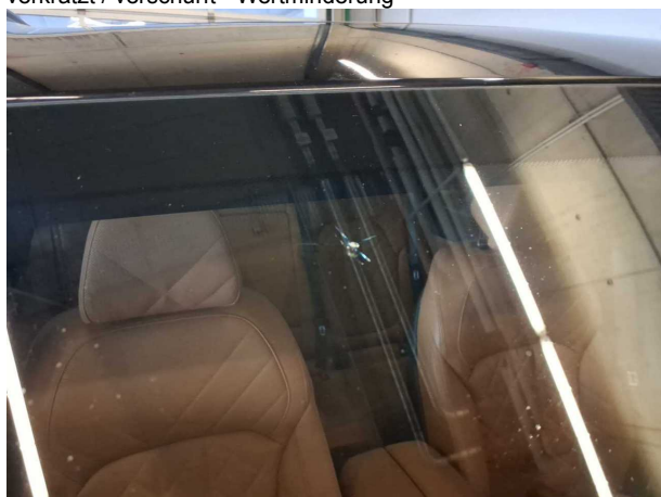
Beschädigung 4: Verglasung: Frontscheibe (RKÜ liegt vor) - Steinschlag - erneuern
