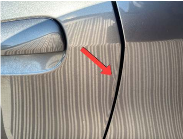
Türe hinten links (Verformung)
