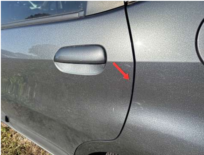
Türe hinten links (Verformung)
