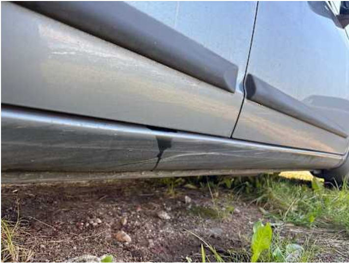
Schweller rechts (Verformung)
