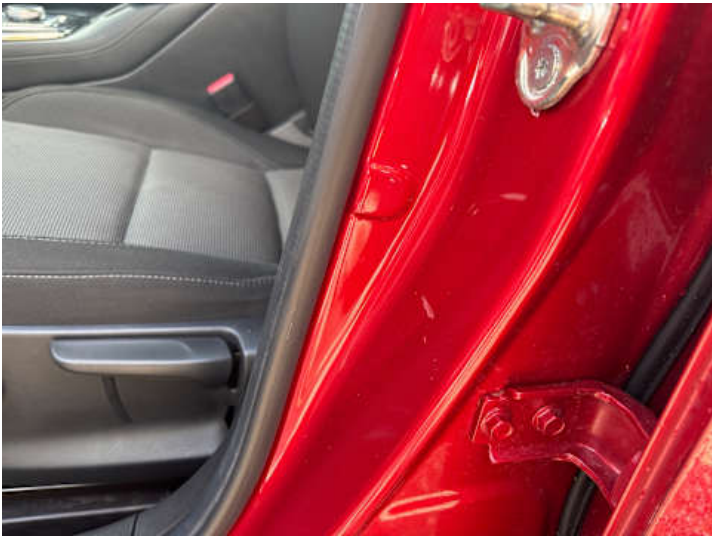
Schweller links (Kratzer)
