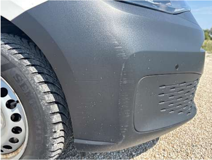
Stoßstange vorne (Kratzer)
