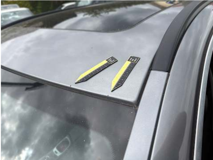
Dach (Steinschlag, Rost)
