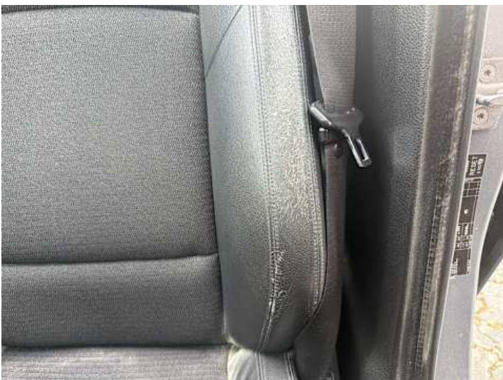
Innenraum (Verschleiß, Verschmutzung)
