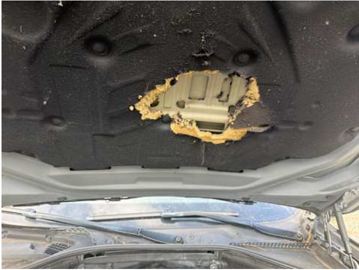
Motorhaube (Anderer Schaden): Dämmwolle angeschmort
