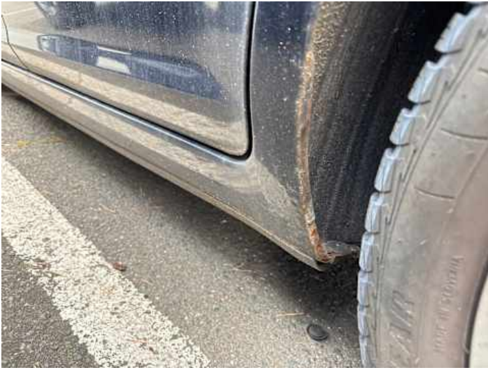
Seitenteil hinten links (Rost)
