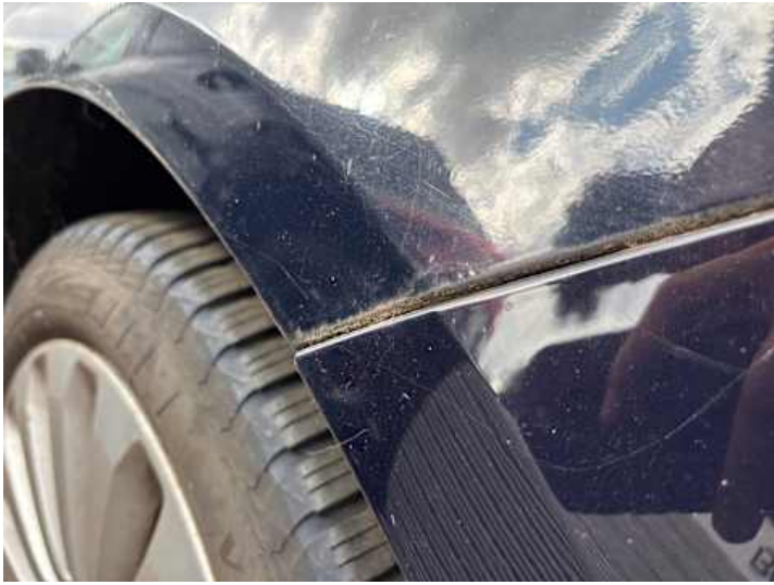
Seitenteil hinten links (Rost)
