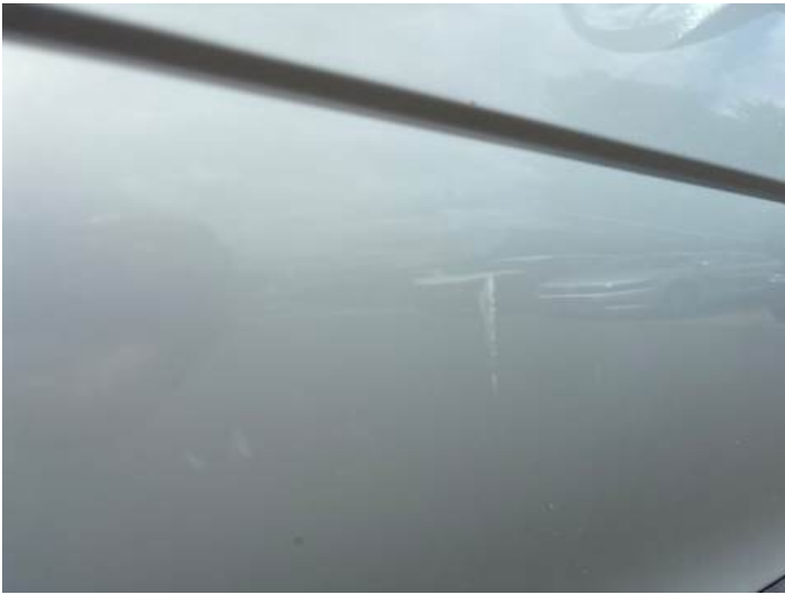
Beifahrertür (Kratzer, Lackschaden)
