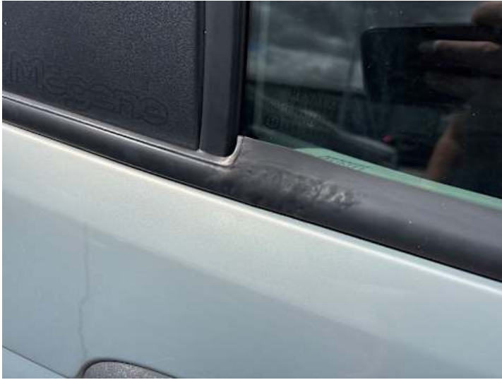
Türe hinten rechts (Rost)
