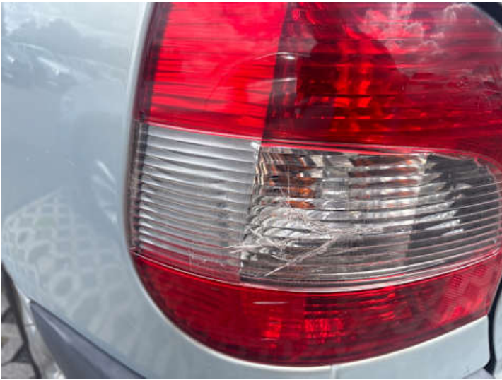
Rücklicht (links) (Kratzer, Riss/Bruch)
