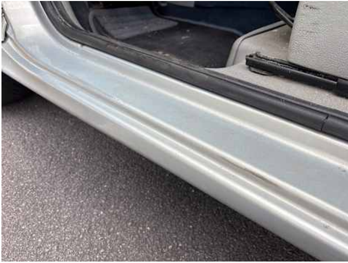
Schweller links (Kratzer, Lackschaden)
