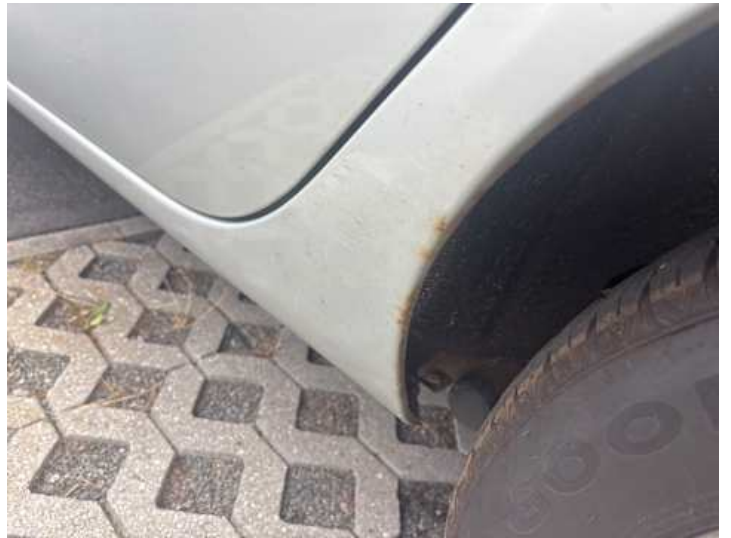
Seitenteil hinten links (Delle, Verformung, Kratzer, Lackschaden)
