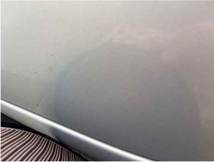
Türe hinten links (Delle, Verformung)
