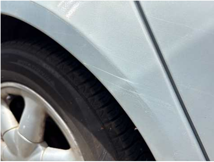
Seitenteil hinten rechts (Kratzer, Lackschaden, Verformung)
