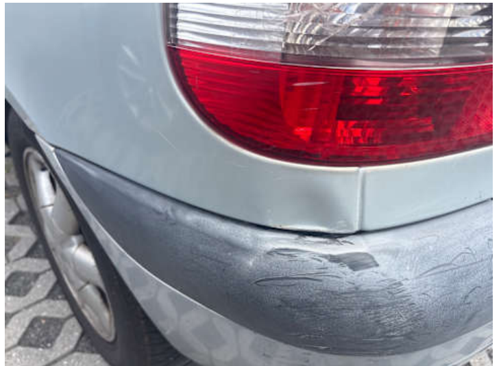
Seitenteil hinten links (Delle, Verformung, Kratzer, Lackschaden)
