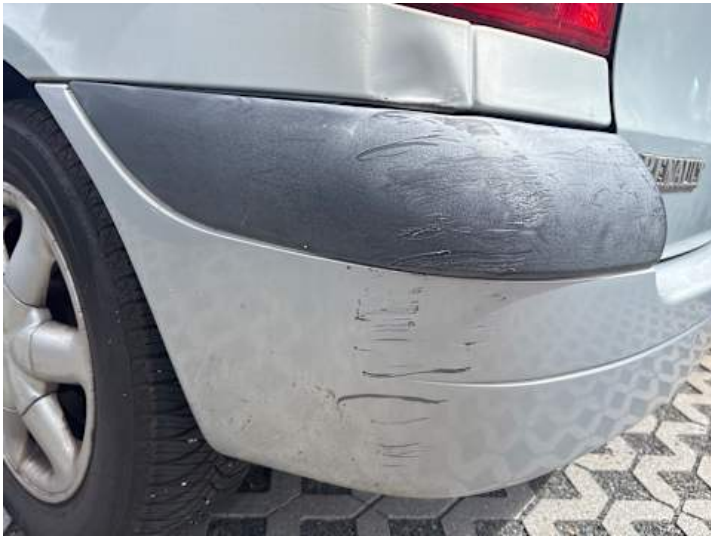
Stoßstange hinten (Kratzer, Lackschaden, Verformung, Riss/Bruch)
