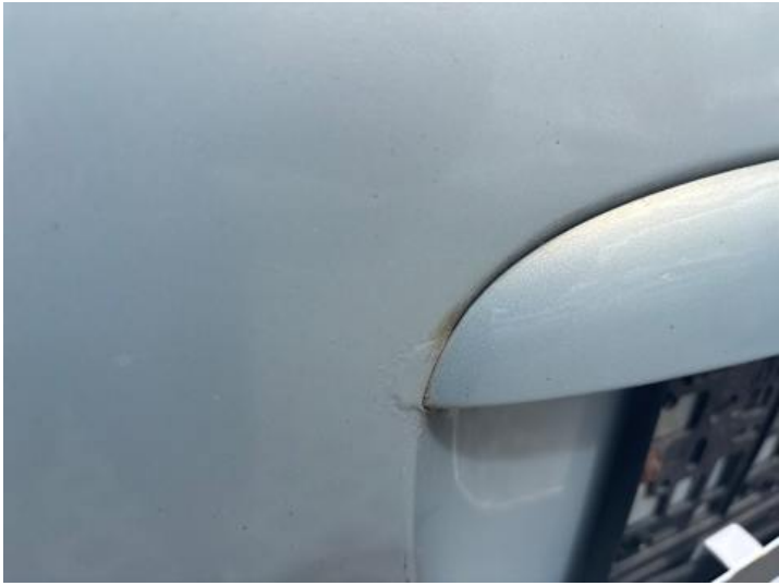
Heckklappe (Delle, Verformung, Kratzer, Rost)
