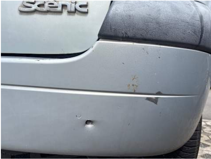
Stoßstange hinten (Kratzer, Lackschaden, Verformung, Riss/Bruch)
