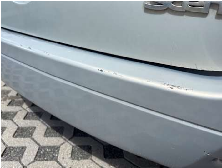
Stoßstange hinten (Kratzer, Lackschaden, Verformung, Riss/Bruch)
