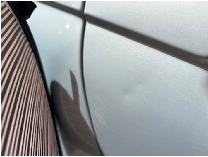
Türe hinten rechts (Delle)
