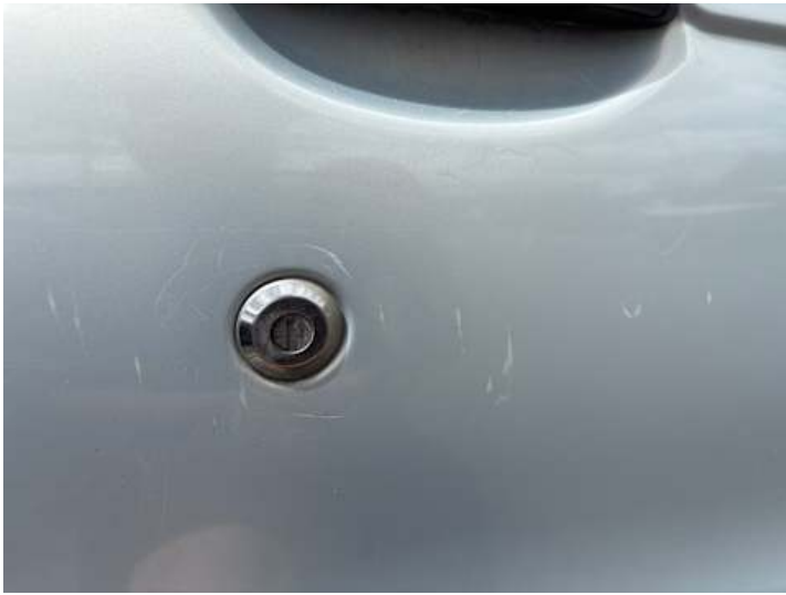
Beifahrertür (Kratzer, Lackschaden)
