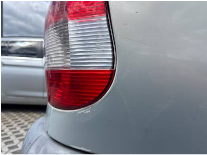
Seitenteil hinten rechts (Kratzer, Lackschaden, Verformung)
