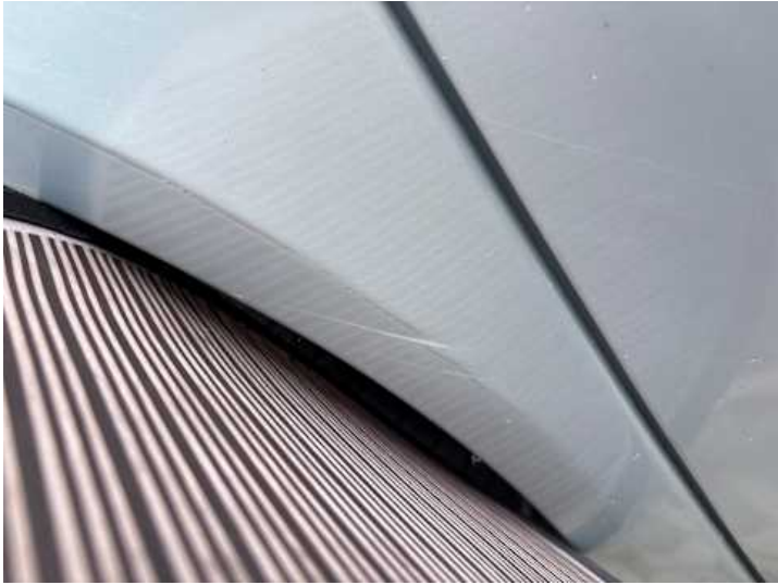
Seitenteil hinten rechts (Kratzer, Lackschaden, Verformung)
