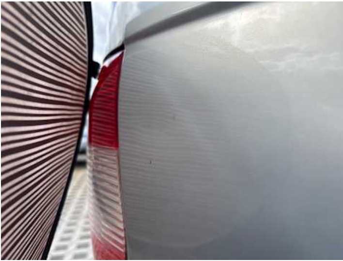
Seitenteil hinten rechts (Kratzer, Lackschaden, Verformung)
