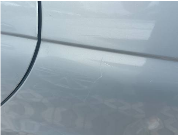
Seitenteil hinten links (Delle, Verformung, Kratzer, Lackschaden)
