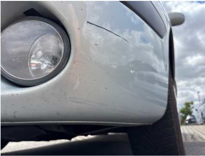
Stoßstange vorne (Kratzer, Lackschaden)
