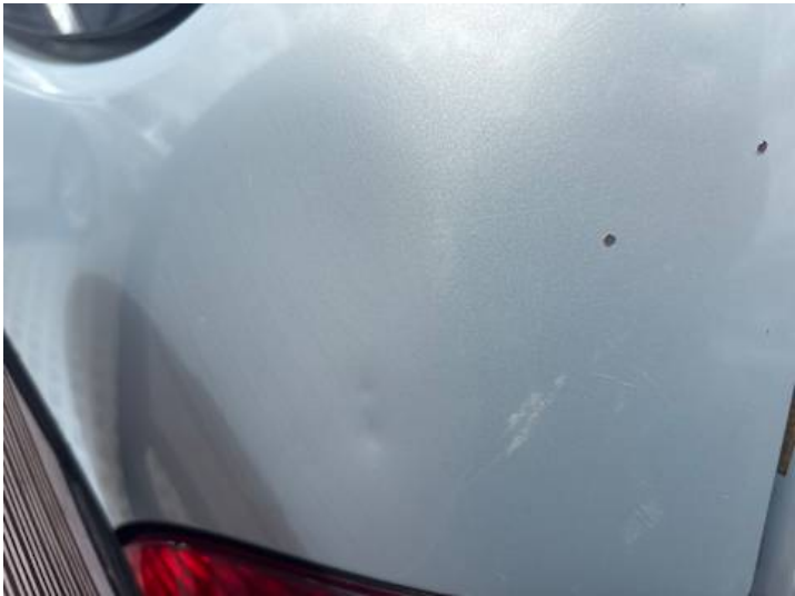
Heckklappe (Delle, Verformung, Kratzer, Rost)
