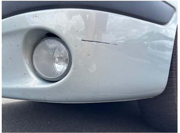
Stoßstange vorne (Kratzer, Lackschaden)
