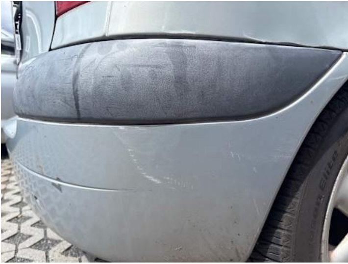
Stoßstange hinten (Kratzer, Lackschaden, Verformung, Riss/Bruch)
