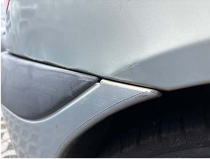
Seitenteil hinten rechts (Kratzer, Lackschaden, Verformung)
