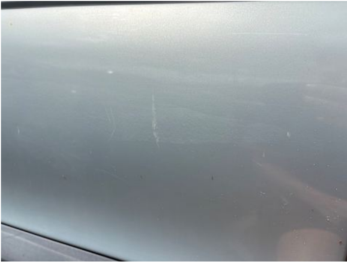
Türe hinten rechts (Kratzer, Lackschaden)
