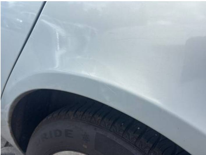
Seitenteil hinten links (Delle, Verformung, Kratzer, Lackschaden)
