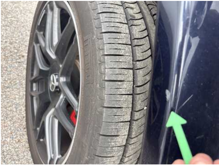
Seitenteil hinten rechts (Kratzer)
